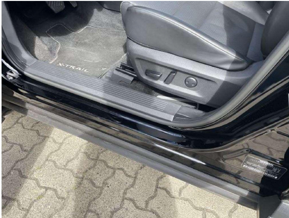
Bild 7 Einstieg Vorne Links - Kratzer > 15mm
