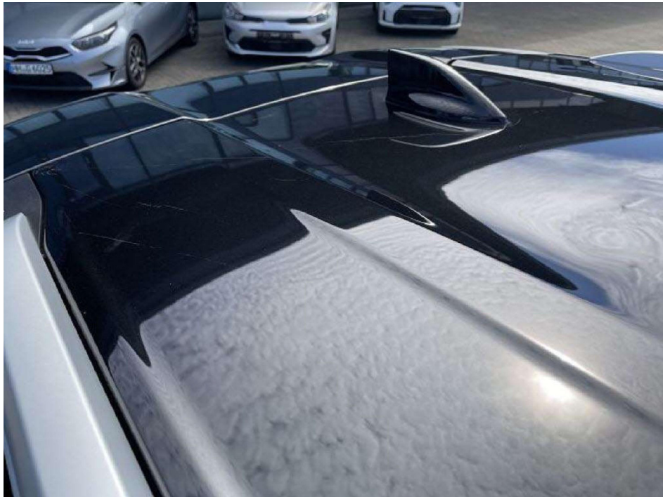
Bild 25 Dach - Kratzer > 50mm
