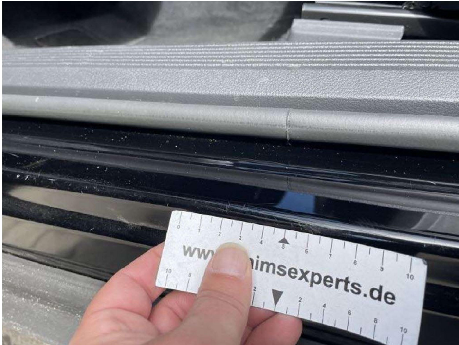
Bild 9 Einstieg Vorne Links - Kratzer > 15mm
