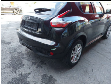
Stoßfänger / Hinten / Kratzer
