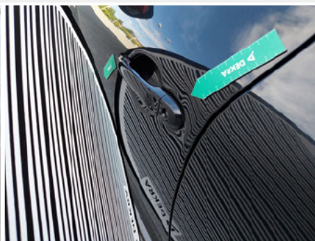
Tür / Vorne Links / Delle
