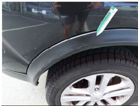
Kotflügelverbreiterung / Hinten Rechts / Kratzer
