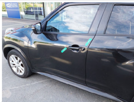
Tür / Vorne Links / Delle
