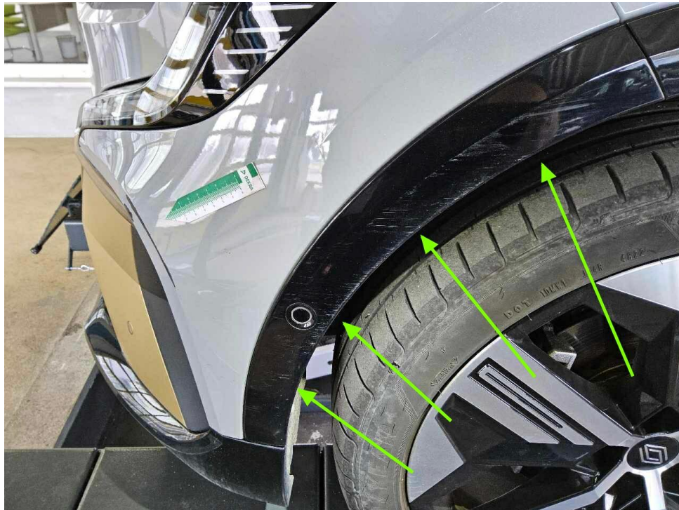
Bild 17 : Stoßfänger vorne und Radlaufblende vorne links zerkratzt
