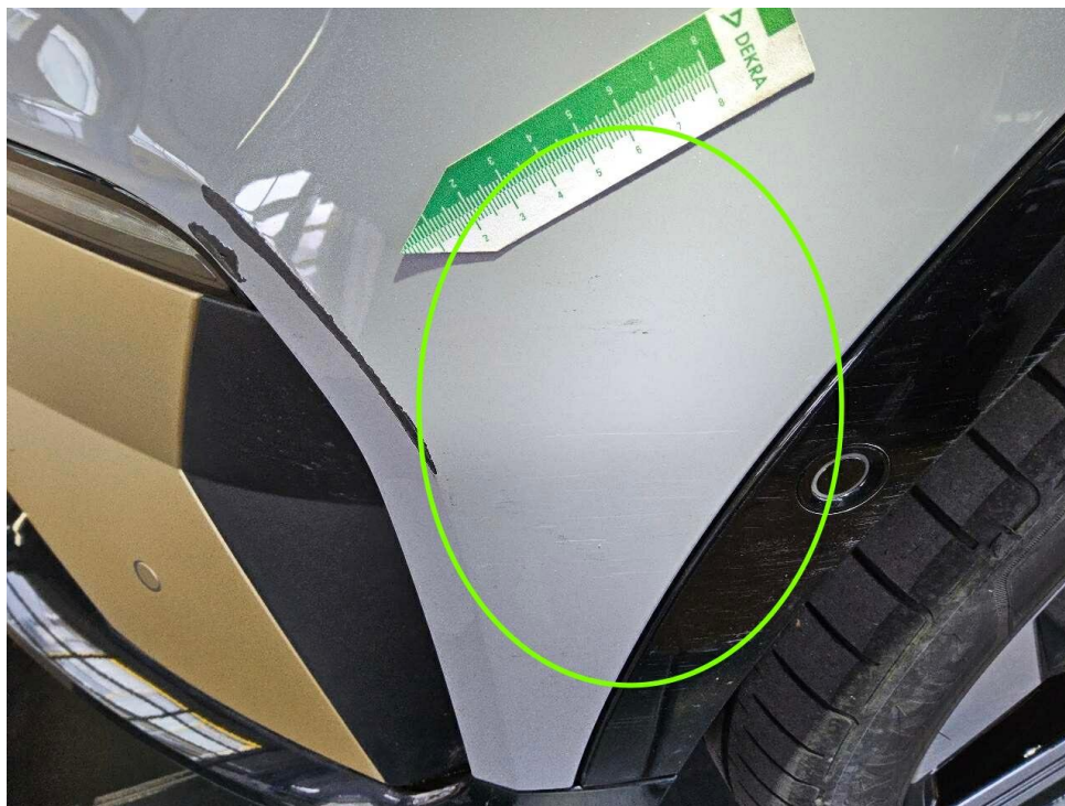
Bild 16 : Stoßfänger vorne und Radlaufblende vorne links zerkratzt
