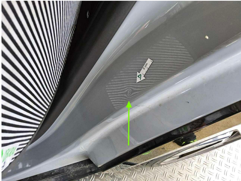
Bild 23 : Tür hinten links Einstieg, eingedellt, drücken
