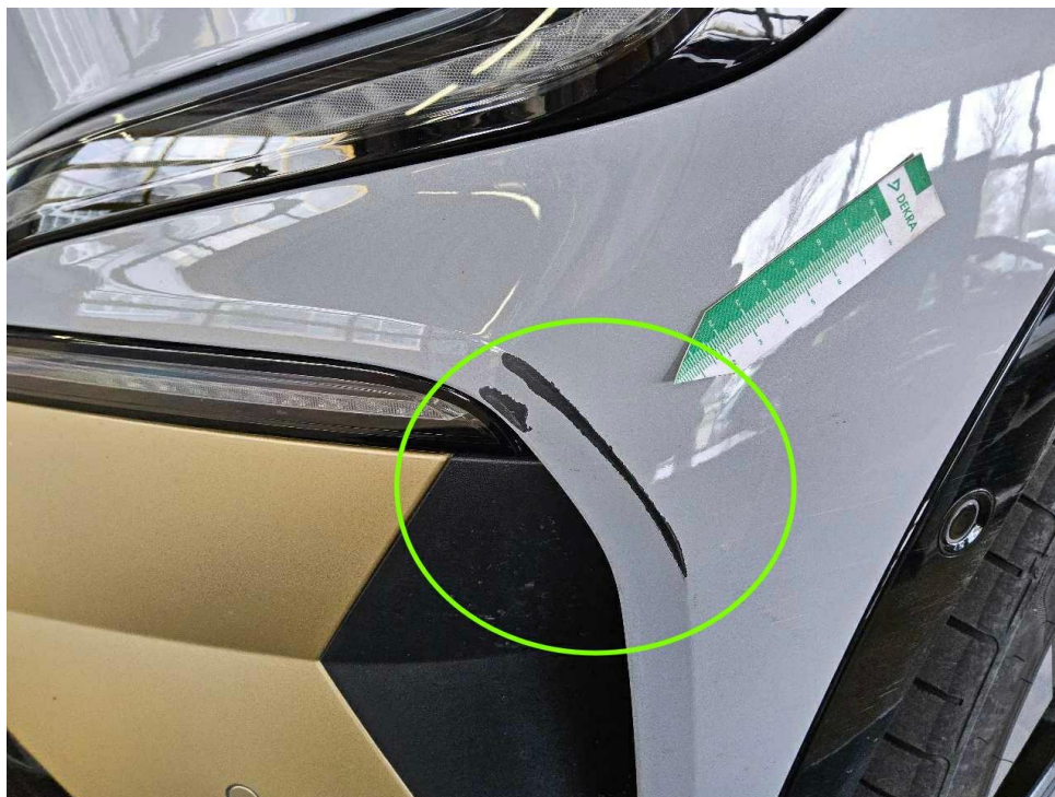
Bild 15 : Stoßfänger vorne und Radlaufblende vorne links zerkratzt
