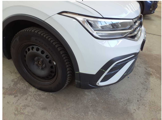
Beschädigung #7: Kotflügel rechts: Radhausverbreiterung - verkratzt / verschürft - erneuern
