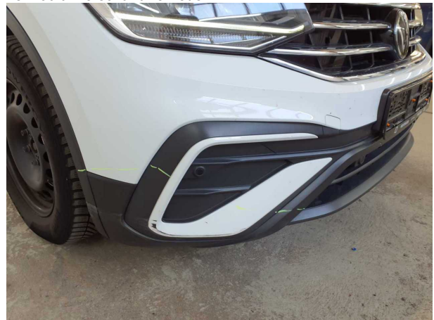
Beschädigung #8: Stossfänger vorn: Spoiler - verkratzt / verschürft - erneuern
