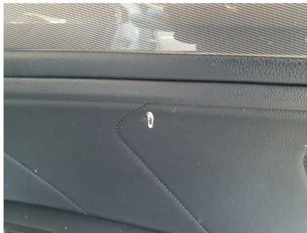
Beschädigung #1: Verkleidungen/Abdeckungen: Türverkleidung vorn rechts - verschmutzt - aufbereiten
