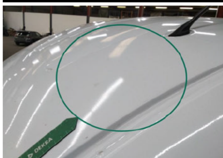
Dach / Vorne / Schlecht Repariert
