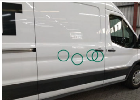
Tür / Rechts / Delle
