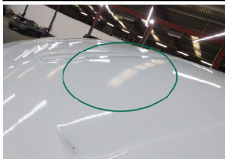
Dach / Vorne / Schlecht Repariert
