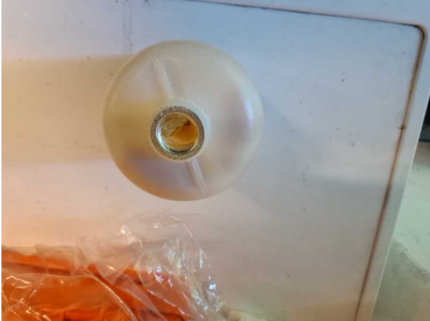
Beschädigung #2: Ausrüstung: Tirefit komplett - beschädigt - erneuern
