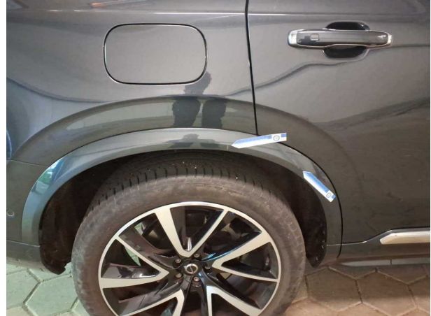
Beschädigung #6: Seitenwand rechts: Radlauf - verkratzt / verschürft - lackieren
