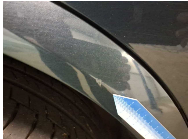
Beschädigung #6: Seitenwand rechts: Radlauf - verkratzt / verschürft - lackieren
