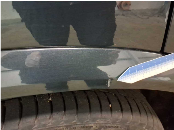
Beschädigung #6: Seitenwand rechts: Radlauf - verkratzt / verschürft - lackieren
