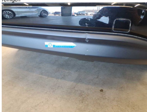
Beschädigung #5: Stossfänger hinten: Spoiler - verformt - erneuern
