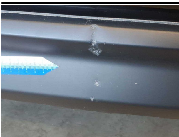
Beschädigung #5: Stossfänger hinten: Spoiler - verformt - erneuern
