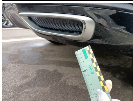
Terminale di scarico / Posteriore Destro / Graffio
