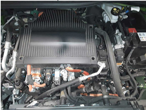
Beschädigung #3: Motorkühlung: Schlauch (Kühlmittelleitung undicht- Marderschaden) - Marderschaden - befunden ggf.
