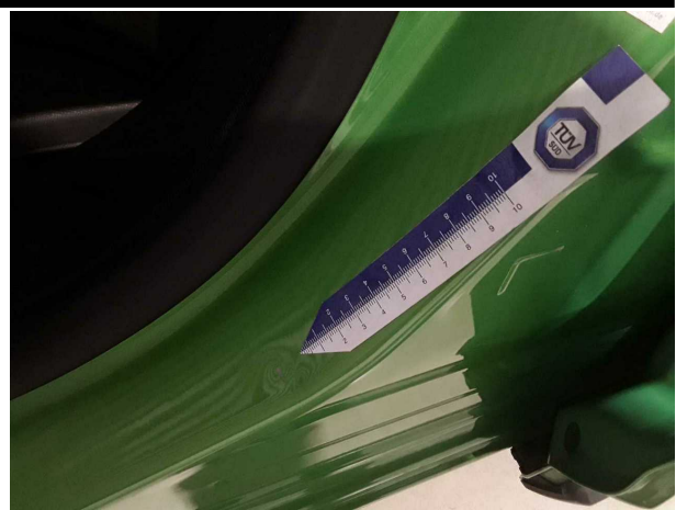
Beschädigung #2: Karosserie: B-Säule links unten - Delle / Lackschaden - Smart Repair
