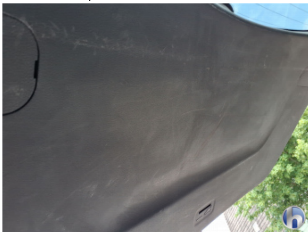
4. Heckklappenverkleidung Beschädigt - Erneuern
