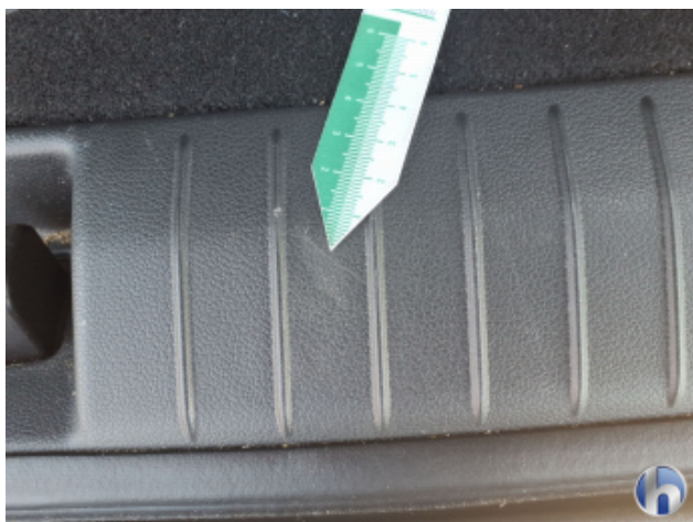
2. Verkleidung Gebrauchsspuren - Ohne Reparatur
