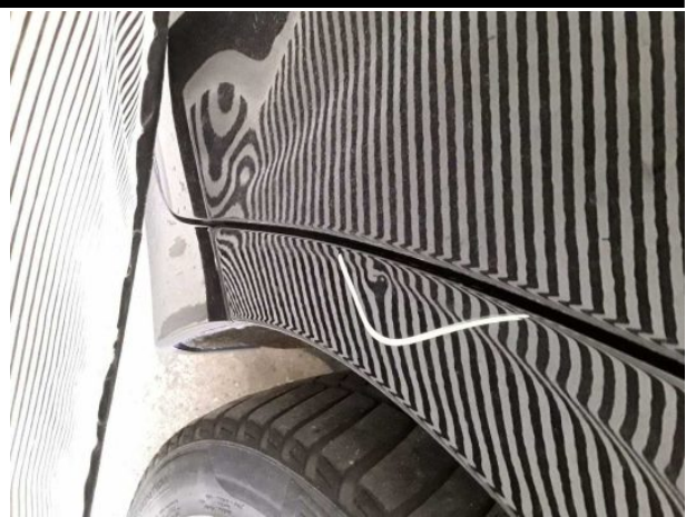
Beschädigung #5: Seitenwand links: Seitenwand - Delle(n) - sanft instandsetzen
