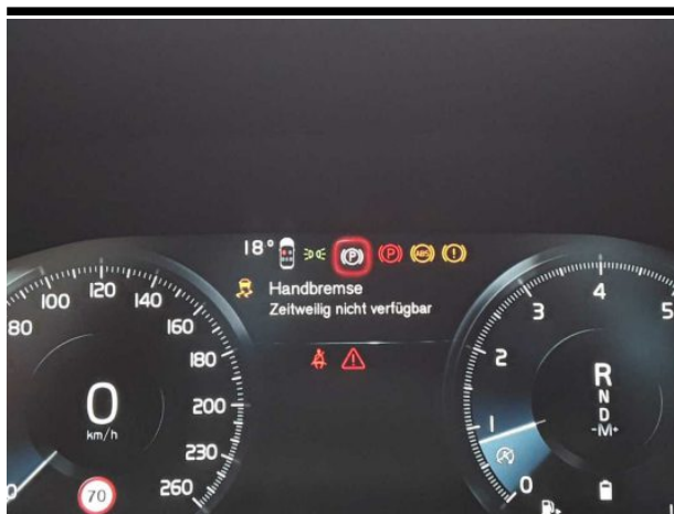
Damage #8: Electronic systems: Electronic systems (Elek. Handbremse zeitweise ohne Funktion laut Anzeige) - Specify
