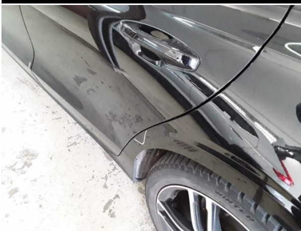
Beschädigung #5: Seitenwand links: Seitenwand - Delle(n) - sanft instandsetzen
