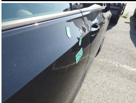
Porte / Arrière Droit / Enfoncement
