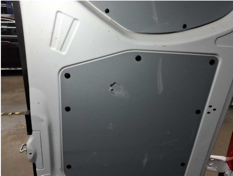
Beschädigung #35: Verkleidungen/Abdeckungen: Laderaum (10x) - gebrochen / gerissen - erneuern
