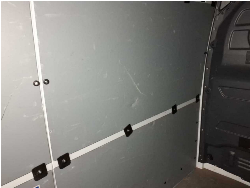
Beschädigung #35: Verkleidungen/Abdeckungen: Laderaum (10x) - gebrochen / gerissen - erneuern
