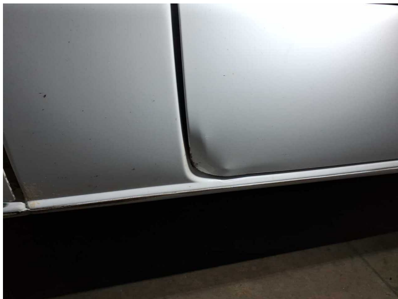
Beschädigung #36: Tür vorn rechts: Tür - verformt - erneuern
