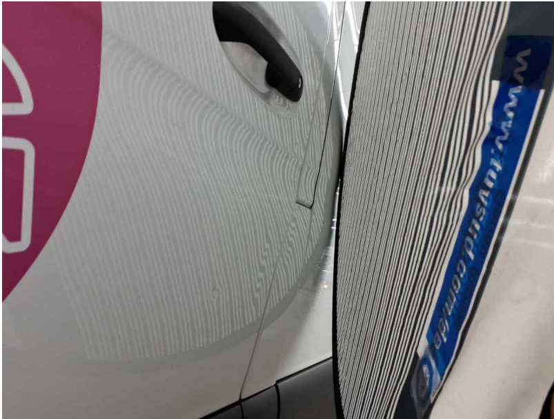
Beschädigung #30: Tür vorn links: Tür (+ Schutzleiste ersetzen) - Delle(n) - instandsetzen und lackieren
