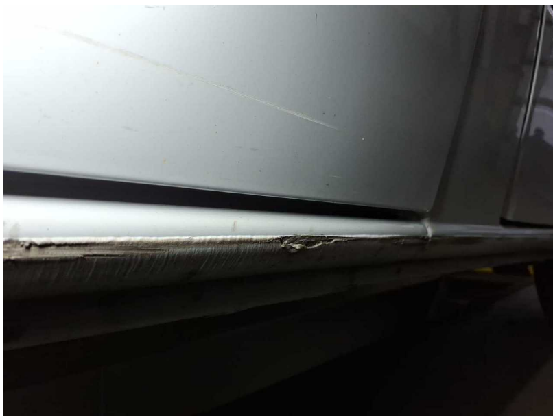
Beschädigung #21: Schweller rechts: Schweller - verkratzt / verschürft - lackieren
