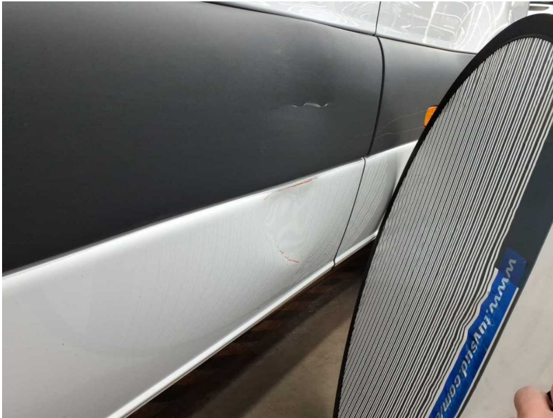
Beschädigung #38: Seitenwand links: Seitenwand Mitte (+ Beplankung inst. + Schutzleiste ersetzen) - Delle(n) - erneuern
