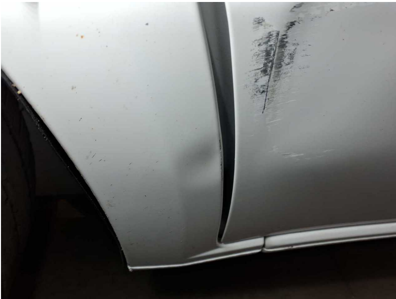
Beschädigung #15: Kotflügel links: Radlauf (Beplankung) - beschädigt - erneuern
