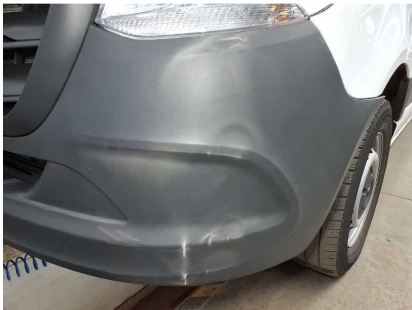
Beschädigung #22: Stossfänger vorn: Stossfänger vorn (Kostenausweitung möglich) - verformt - erneuern
