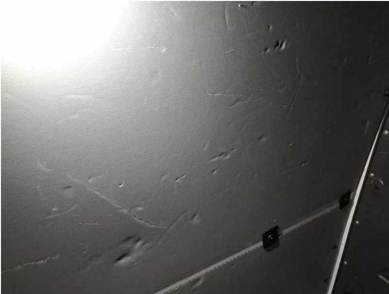
Beschädigung #35: Verkleidungen/Abdeckungen: Laderaum (10x) - gebrochen / gerissen - erneuern
