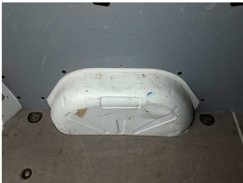
Beschädigung #31: Laderaum/Fahrgastraum: Laderaum/Fahrgastraum - beschädigt - instandsetzen und lackieren
