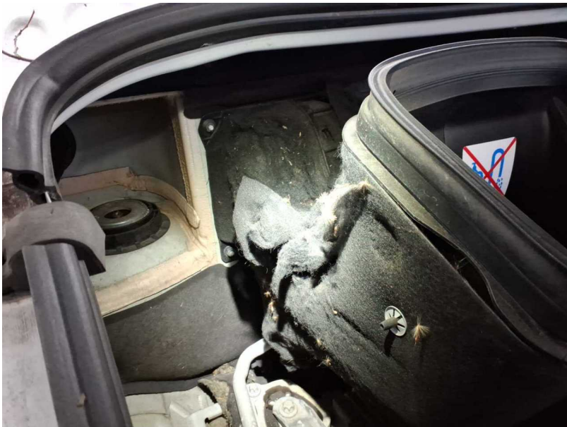
Beschädigung #20: Fahrerhaus: Dämmmatte (2x, Kostenausweitung möglich) - Marderschaden - erneuern
