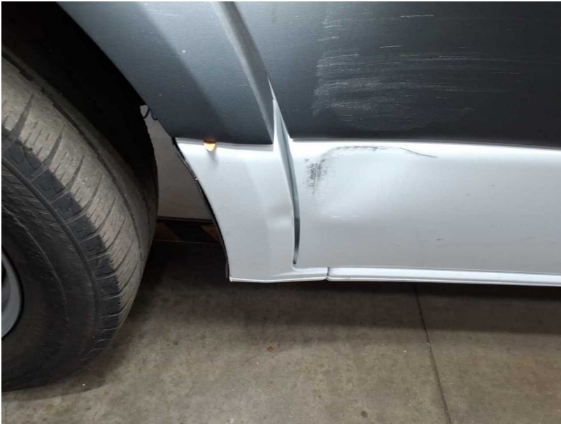
Beschädigung #15: Kotflügel links: Radlauf (Beplankung) - beschädigt - erneuern
