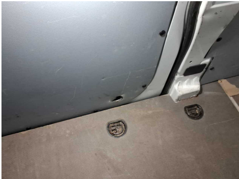
Beschädigung #35: Verkleidungen/Abdeckungen: Laderaum (10x) - gebrochen / gerissen - erneuern
