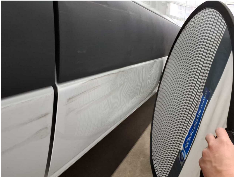
Beschädigung #37: Schiebetür rechts: Schiebetür (+ Schutzleiste) - verformt - erneuern
