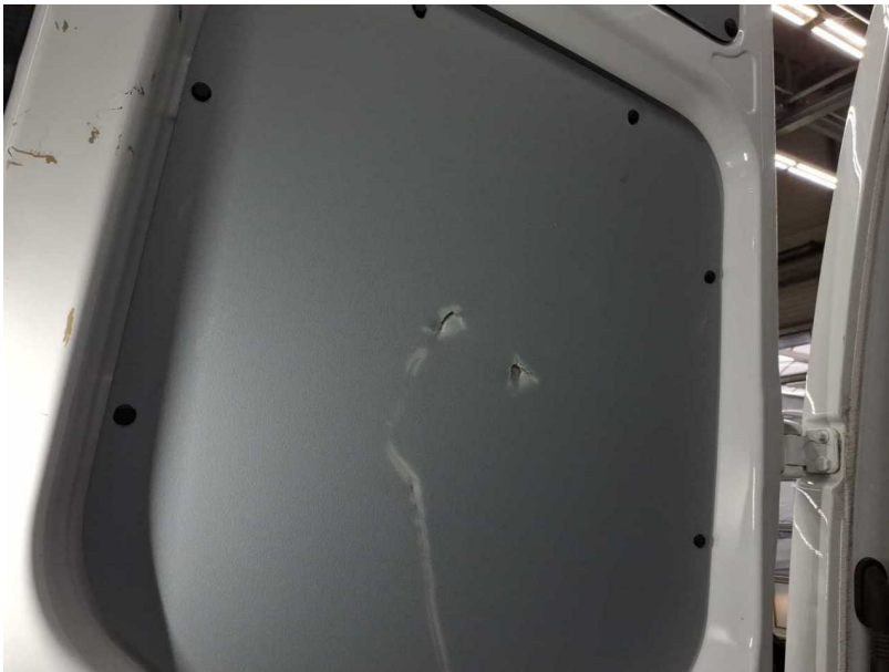
Beschädigung #35: Verkleidungen/Abdeckungen: Laderaum (10x) - gebrochen / gerissen - erneuern
