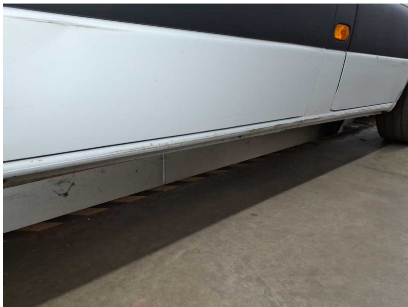
Beschädigung #21: Schweller rechts: Schweller - verkratzt / verschürft - lackieren
