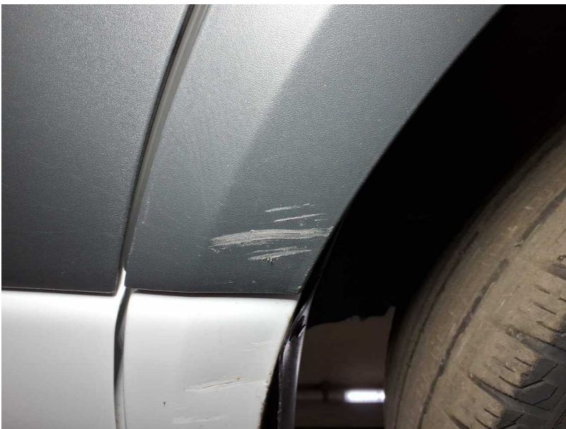
Beschädigung #19: Kotflügel rechts: Kotflügel rechts (Beplankung und Schutzleiste) - verformt - erneuern
