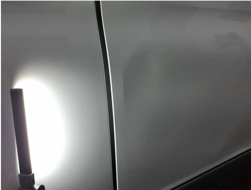
Beschädigung #37: Schiebetür rechts: Schiebetür (+ Schutzleiste) - verformt - erneuern
