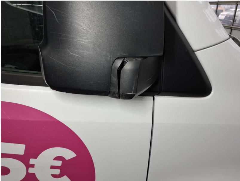
Beschädigung #14: Außenspiegel rechts: Rahmen (Kostenausweitung möglich) - gebrochen / gerissen - erneuern
