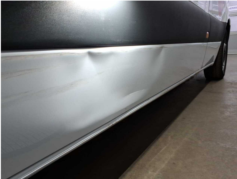
Beschädigung #37: Schiebetür rechts: Schiebetür (+ Schutzleiste) - verformt - erneuern
