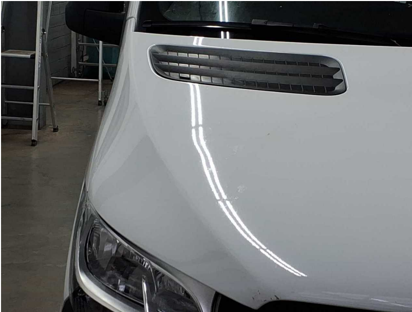
Beschädigung #29: Motorhaube: Motorhaube - Delle(n) - instandsetzen und lackieren
