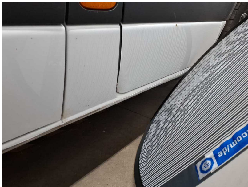
Beschädigung #36: Tür vorn rechts: Tür - verformt - erneuern
