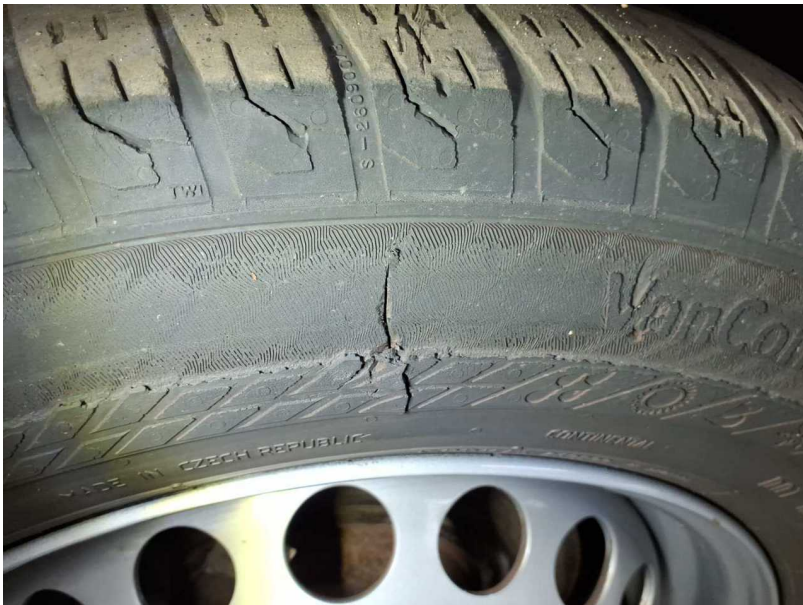
Beschädigung #6: Rad/Reifen: Reifen vorn links - beschädigt - erneuern
