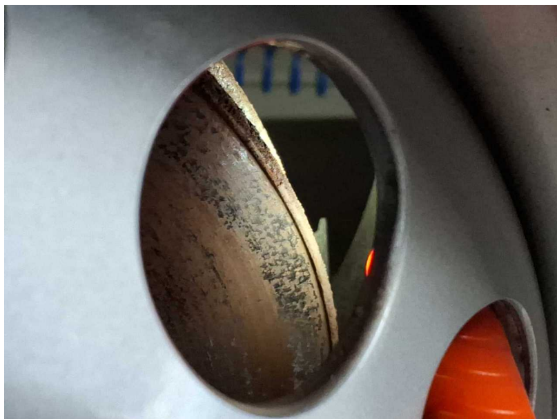
Beschädigung #25: Bremsanlage: Bremsscheiben und Beläge vorn - verschlissen - erneuern
