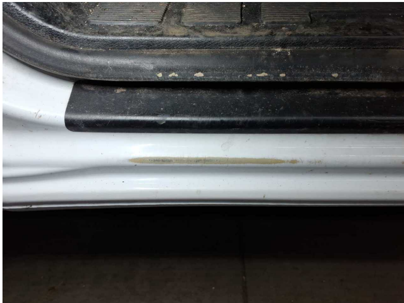
Beschädigung #17: Schweller links: Einstieg - Kratzer - lackieren
