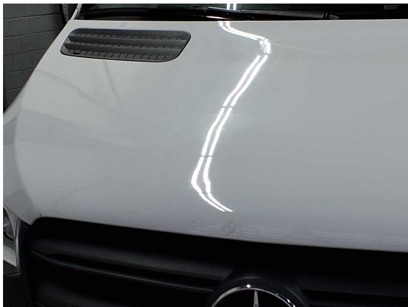
Beschädigung #29: Motorhaube: Motorhaube - Delle(n) - instandsetzen und lackieren
