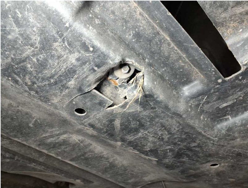
Beschädigung #10: Motor: Motorverkleidung unten (Kostenausweitung möglich) - gebrochen / gerissen - erneuern
