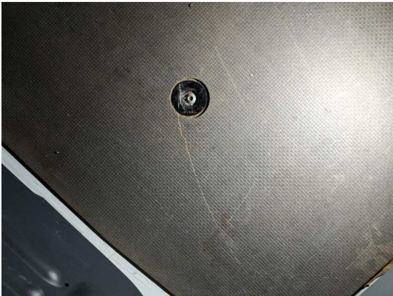
Beschädigung #24: Heckbereich: Holzboden - verkratzt / verschürft - Wertminderung
