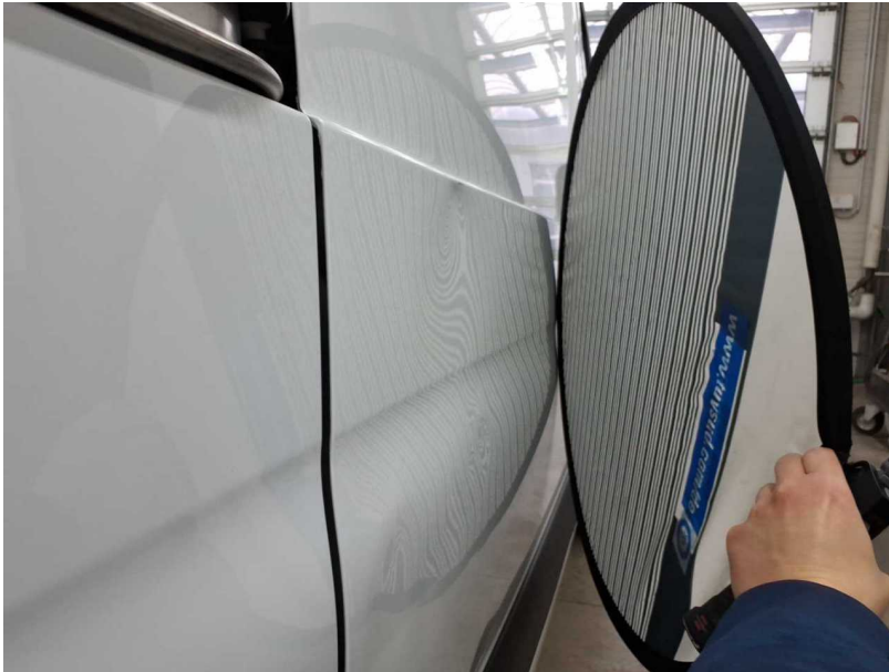
Beschädigung #37: Schiebetür rechts: Schiebetür (+ Schutzleiste) - verformt - erneuern
