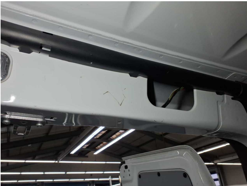
Beschädigung #31: Laderaum/Fahrgastraum: Laderaum/Fahrgastraum - beschädigt - instandsetzen und lackieren
