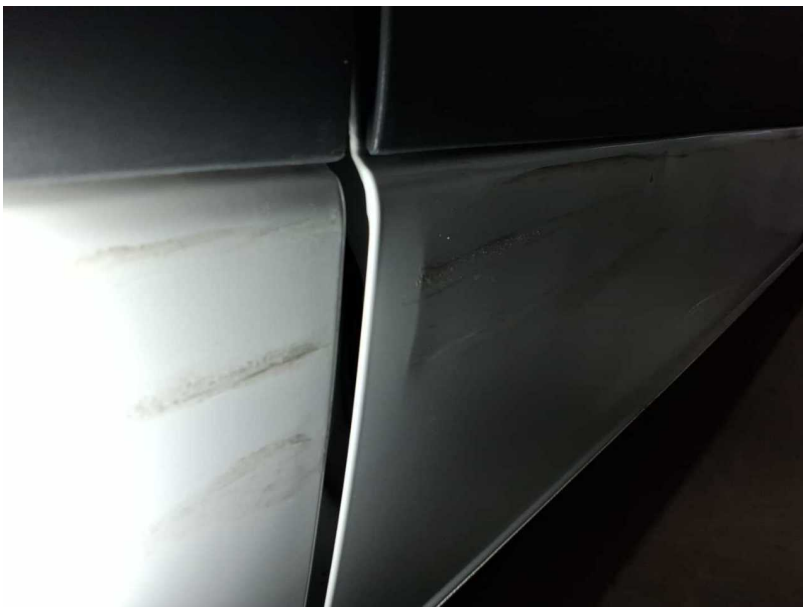
Beschädigung #37: Schiebetür rechts: Schiebetür (+ Schutzleiste) - verformt - erneuern
