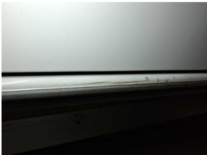
Beschädigung #21: Schweller rechts: Schweller - verkratzt / verschürft - lackieren
