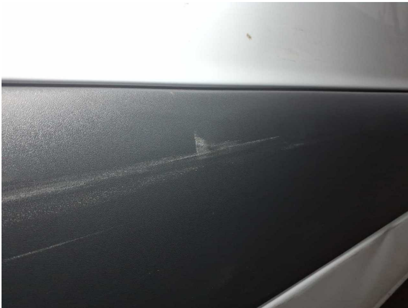
Beschädigung #37: Schiebetür rechts: Schiebetür (+ Schutzleiste) - verformt - erneuern
