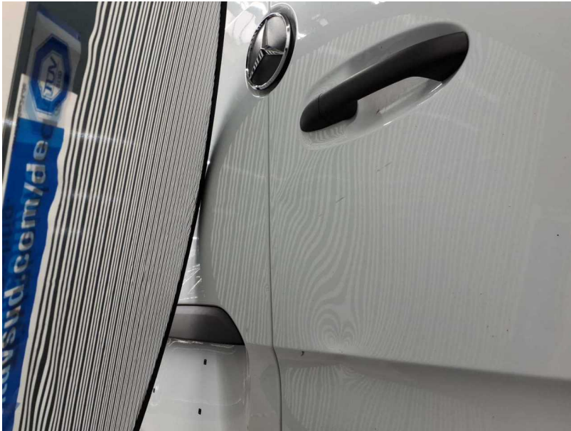
Beschädigung #34: Heckklappe/-tür: Hecktür rechts - Delle(n) - instandsetzen und lackieren
