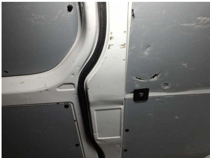
Beschädigung #31: Laderaum/Fahrgastraum: Laderaum/Fahrgastraum - beschädigt - instandsetzen und lackieren
