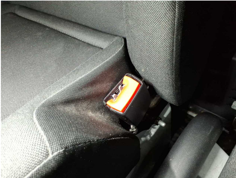
Beschädigung #5: Gurtsystem vorn: Gurtschloss Mitte - gebrochen / gerissen - erneuern
