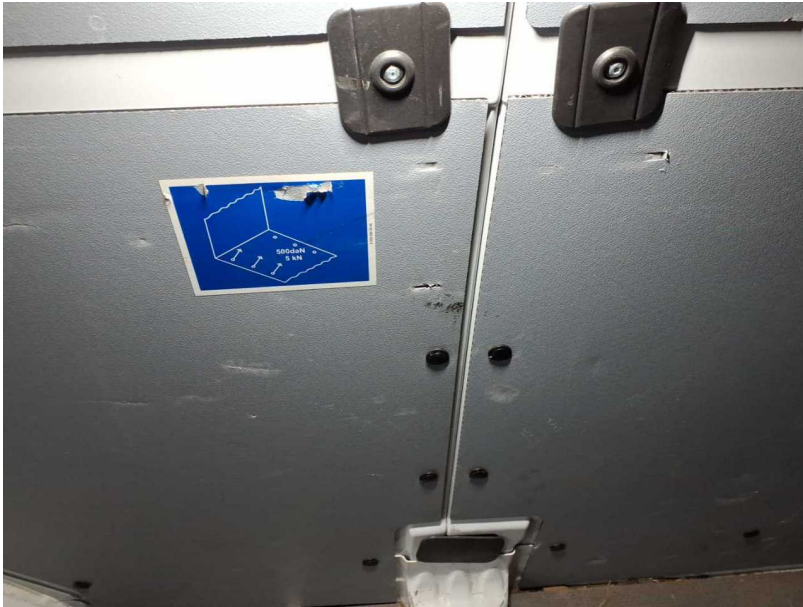
Beschädigung #35: Verkleidungen/Abdeckungen: Laderaum (10x) - gebrochen / gerissen - erneuern
