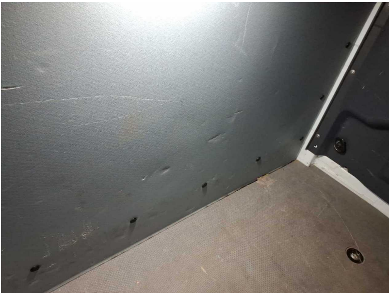
Beschädigung #35: Verkleidungen/Abdeckungen: Laderaum (10x) - gebrochen / gerissen - erneuern
