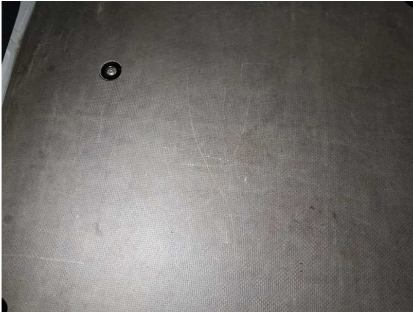
Beschädigung #24: Heckbereich: Holzboden - verkratzt / verschürft - Wertminderung
