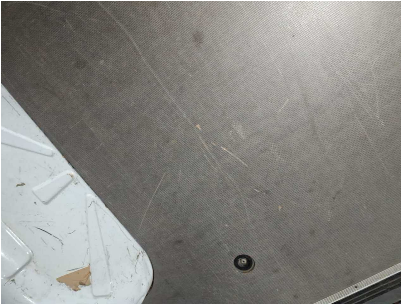
Beschädigung #24: Heckbereich: Holzboden - verkratzt / verschürft - Wertminderung
