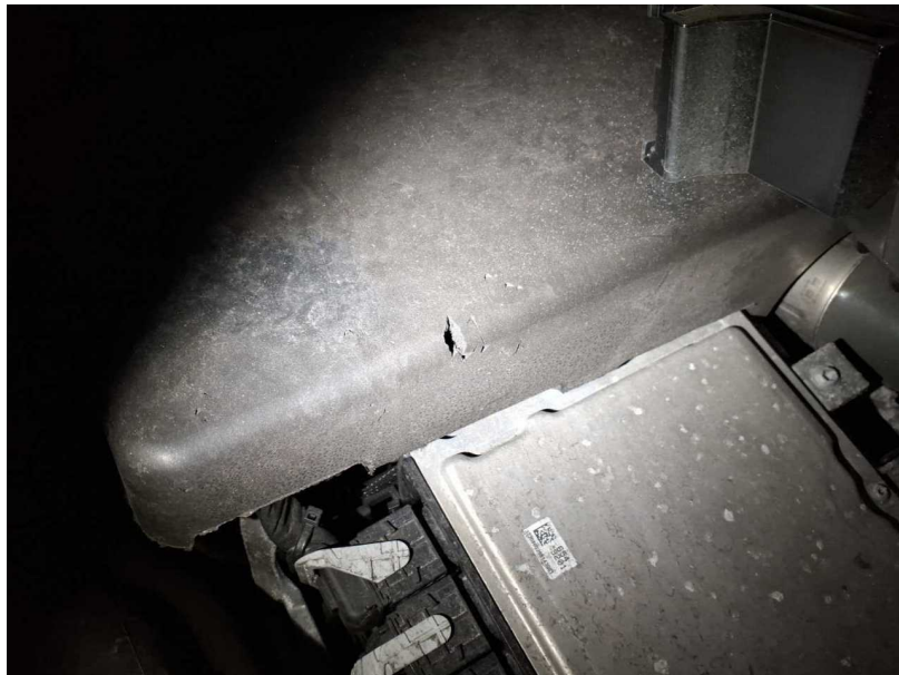
Beschädigung #12: Motor: Motorabdeckung oben / Blende (Kostenausweitung möglich) - Marderschaden - erneuern
