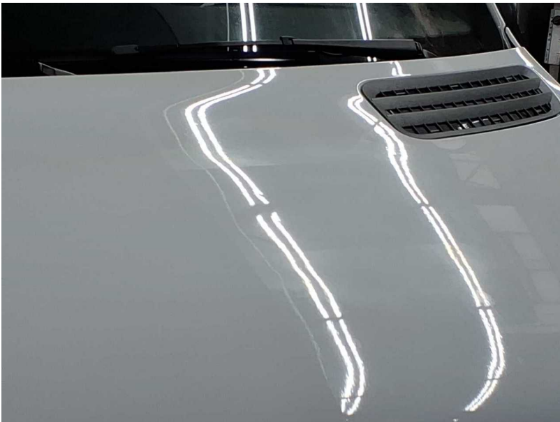
Beschädigung #29: Motorhaube: Motorhaube - Delle(n) - instandsetzen und lackieren
