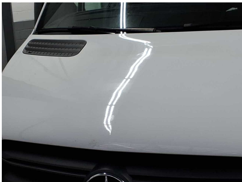
Beschädigung #29: Motorhaube: Motorhaube - Delle(n) - instandsetzen und lackieren
