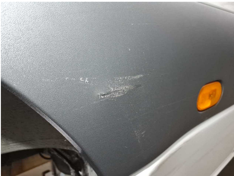
Beschädigung #23: Seitenwand rechts: Seitenwand vorn unterhalb (+ Schutzleiste ersetzen) - Delle(n) - instandsetzen und lackieren
