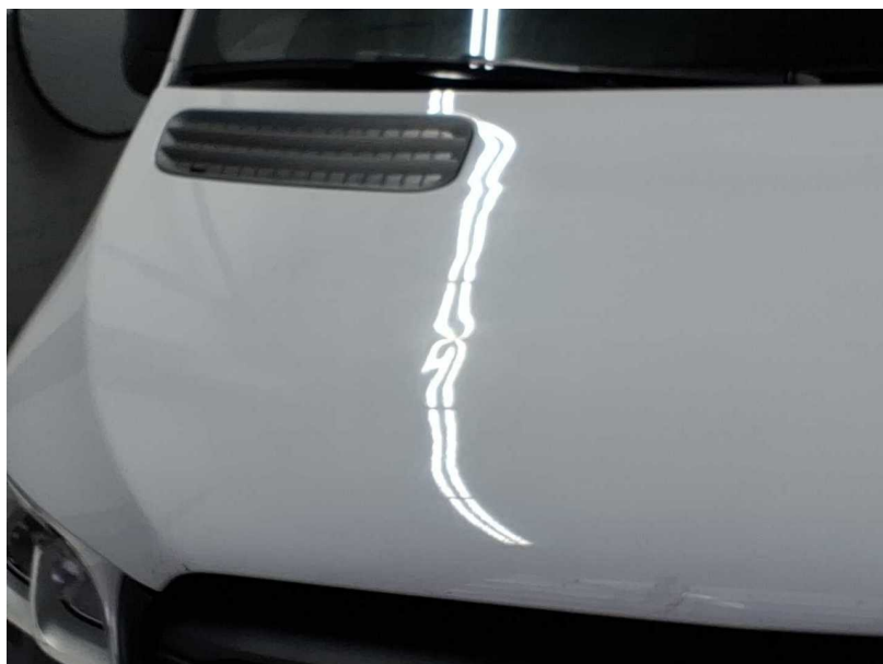
Beschädigung #29: Motorhaube: Motorhaube - Delle(n) - instandsetzen und lackieren
