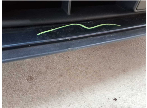
Beschädigung #3: Stossfänger vorn: Spoiler - verkratzt / verschürft - Wertminderung
