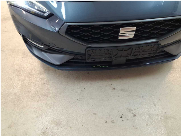
Beschädigung #3: Stossfänger vorn: Spoiler - verkratzt / versch... - Wertminderung
