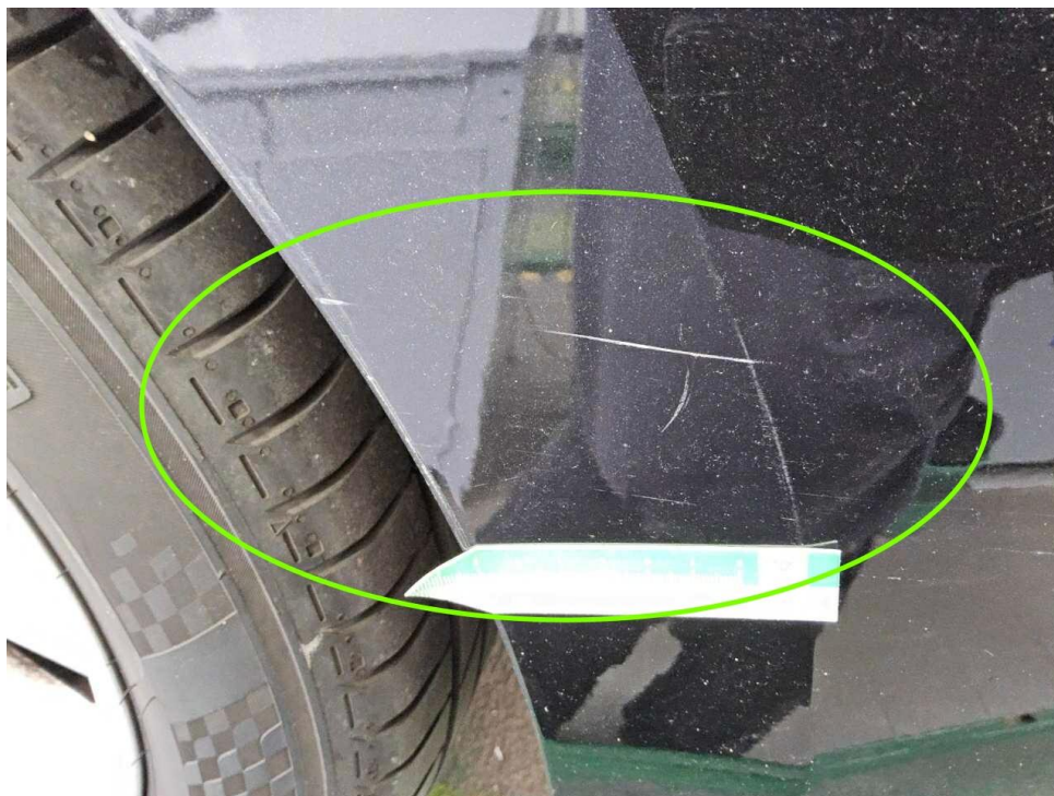
Bild 19 : Stoßfänger hinten Lackierung, zerkratzt, smart repair
