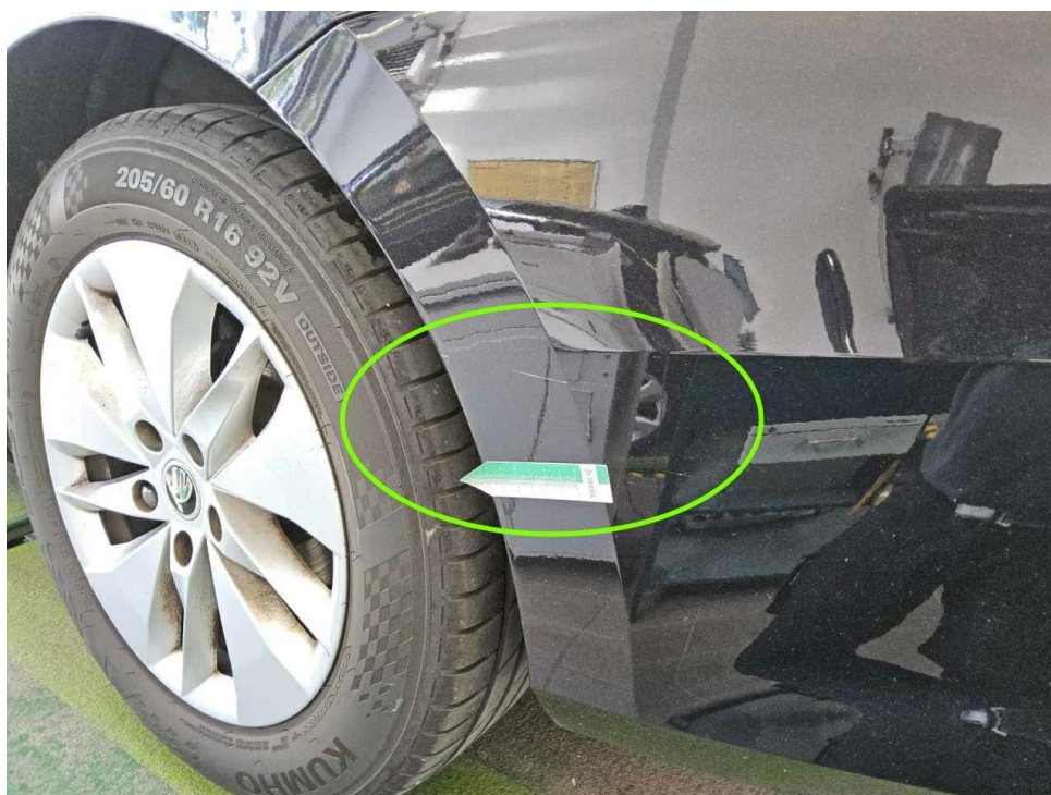
Bild 18 : Stoßfänger hinten Lackierung, zerkratzt, smart repair
