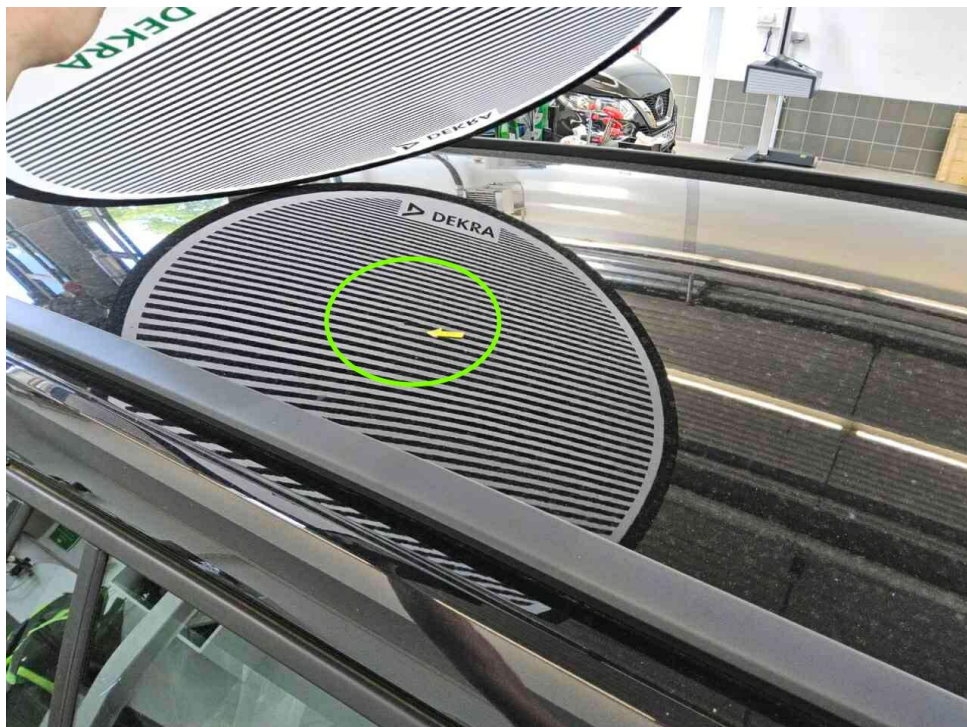
Bild 16 : Dach, eingedellt, drücken
