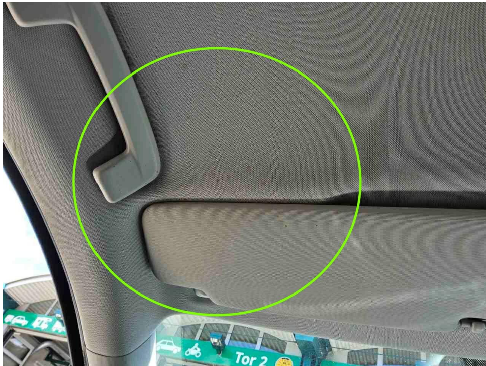
Bild 15 : Dachhimmel, fleckig, reinigen
