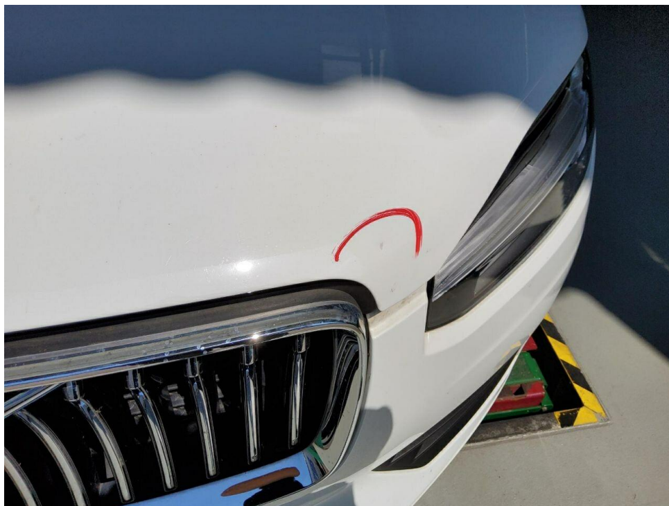
Bild 22 : Motorhaube Lackierung, zerkratzt, lackieren mit Lackaufbau
