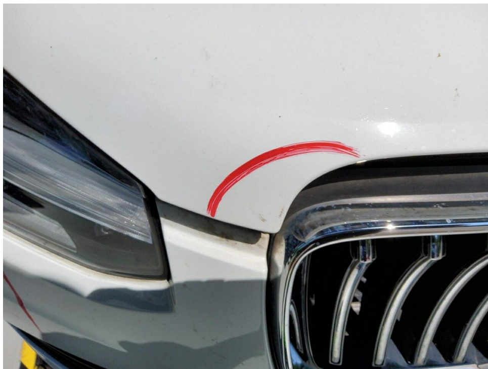
Bild 23 : Motorhaube Lackierung, zerkratzt, lackieren mit Lackaufbau
