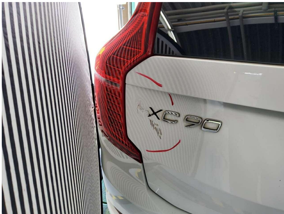
Bild 21 : Heckklappe, deformiert, instandsetzen und lackieren mit Lackaufbau
