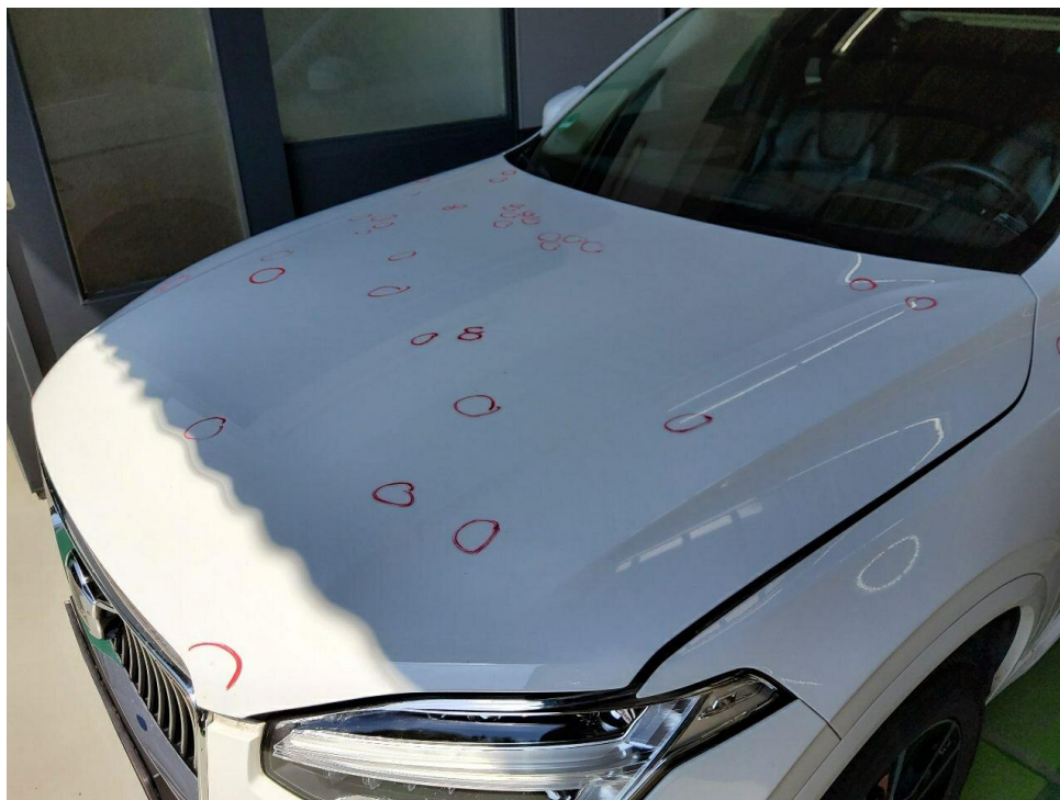
Bild 27 : Elementarschaden. Separates Gutachten erforderlich. Kosten geschätzt
