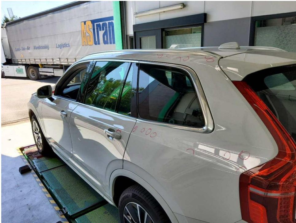
Bild 29 : Elementarschaden. Separates Gutachten erforderlich. Kosten geschätzt
