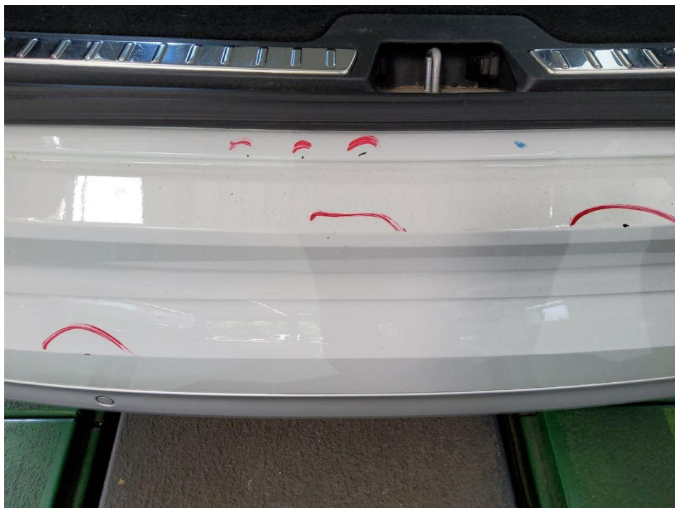
Bild 18 : Stoßfänger hinten Lackierung, zerkratzt, lackieren mit Lackaufbau
