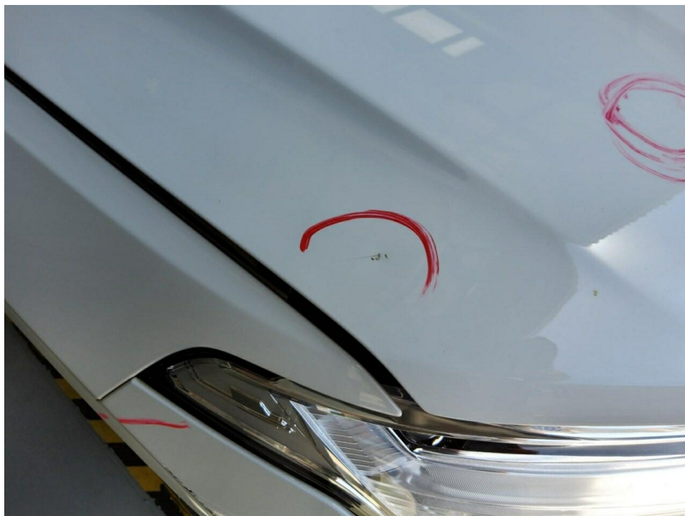
Bild 24 : Motorhaube Lackierung, zerkratzt, lackieren mit Lackaufbau
