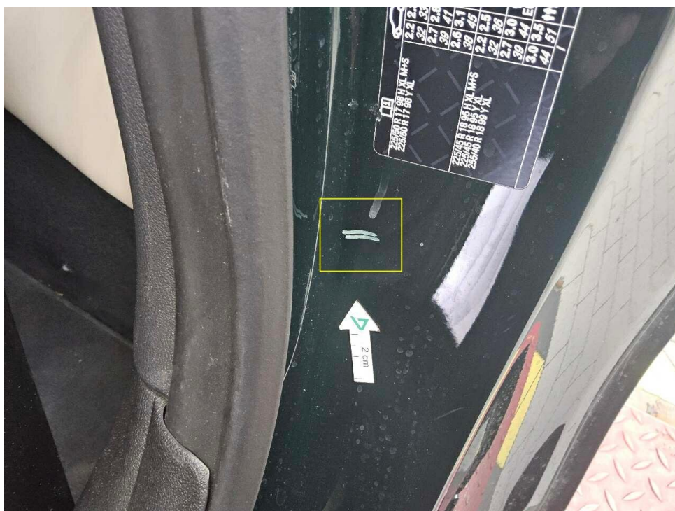
Bild 18 : Tür links Einstieg, zerkratzt
