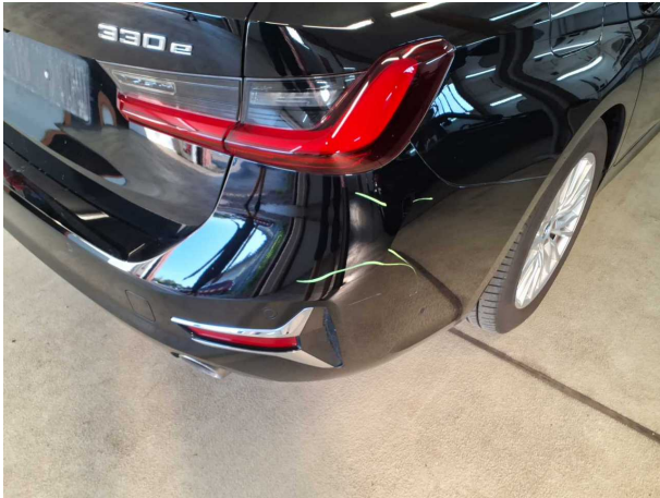
Beschädigung #1: Stossfänger hinten: Stossfänger hinten - verkratzt / verschürft - instandsetzen und lackieren
