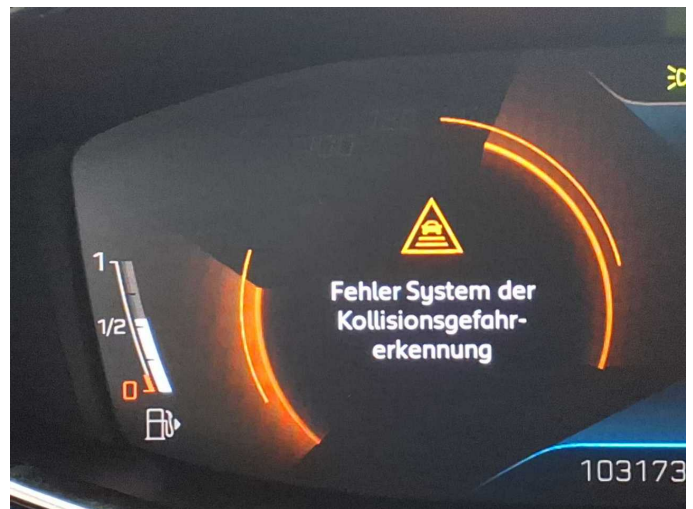
Damage 4: Instrument panel: Indicator light (Kollisionsgefahrerkennung) - on - Perform diagnosis
