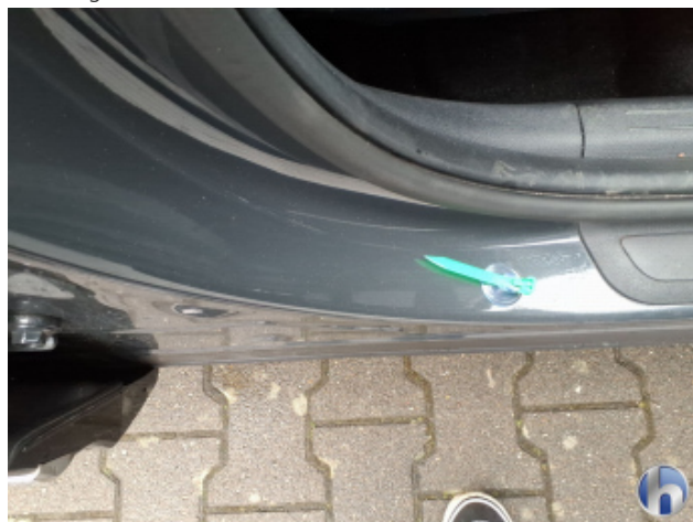
1. Schweller - Rechts Kratzer - Smart Repair
