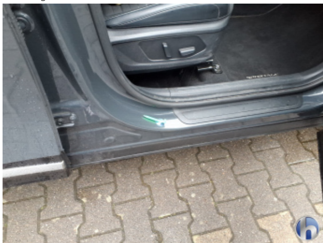
1. Schweller - Rechts Kratzer - Smart Repair
