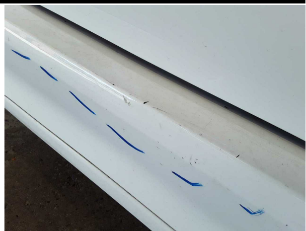
Beschädigung #7: Stossfänger hinten: Stossfänger hinten - verformt - erneuern
