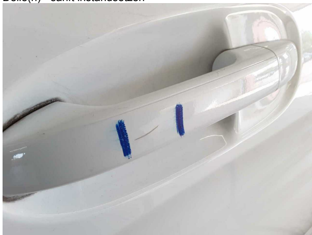
Beschädigung #4: Tür hinten links: Griff außen - verkratzt / verschürft - Smart Repair
