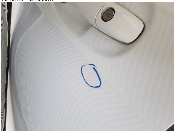
Beschädigung #8: Tür vorn links: Tür - Delle / Lackschaden - instandsetzen und lackieren
