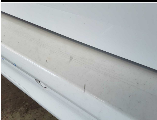
Beschädigung #7: Stossfänger hinten: Stossfänger hinten - verformt - erneuern
