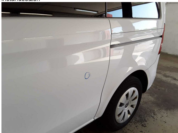
Beschädigung #3: Schiebetür links: Schiebetür mit Glasscheibe - Delle(n) - sanft instandsetzen
