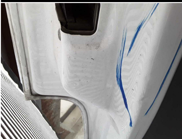
Beschädigung #8: Tür vorn links: Tür - Delle / Lackschaden - instandsetzen und lackieren
