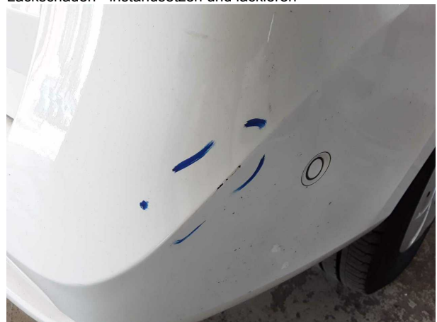
Beschädigung #7: Stossfänger hinten: Stossfänger hinten - verformt - erneuern
