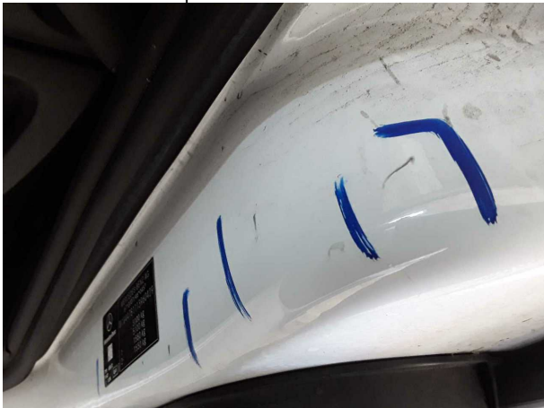
Beschädigung #6: Schweller links: Einstieg - Delle / Lackschade... instandsetzen und lackieren
