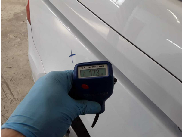
Nachlackierung 1: Seitenwand rechts, Tür hinten rechts
