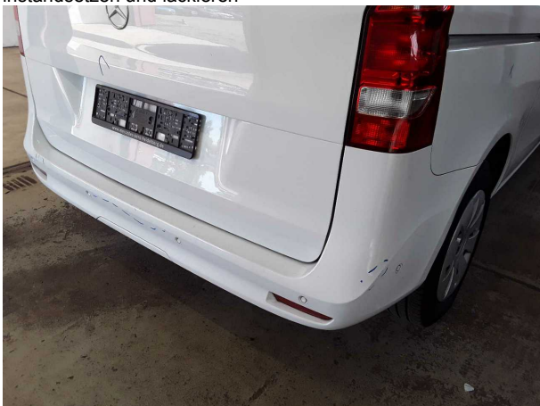
Beschädigung #7: Stossfänger hinten: Stossfänger hinten - verformt - erneuern
