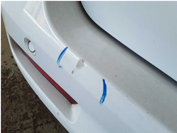
Beschädigung #7: Stossfänger hinten: Stossfänger hinten - verformt - erneuern
