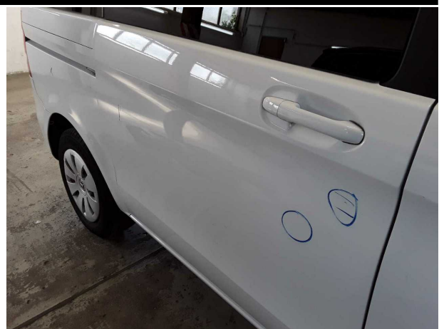
Beschädigung #9: Schiebetür rechts: Schiebetür mit Glasscheibe - Delle / Lackschaden - instandsetzen und
