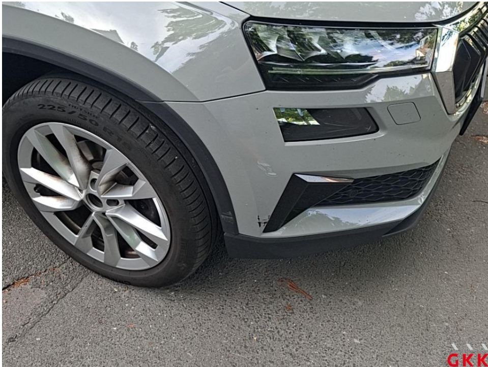
Bild 20. Stoßfänger vorne, Leiste, Radlauf, verkratzt, ersetzen
