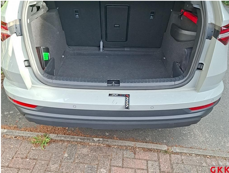
Bild 28. Stoßfänger hinten, Verkleidung oberhalb -lackiert-, verkratzt, lackieren
