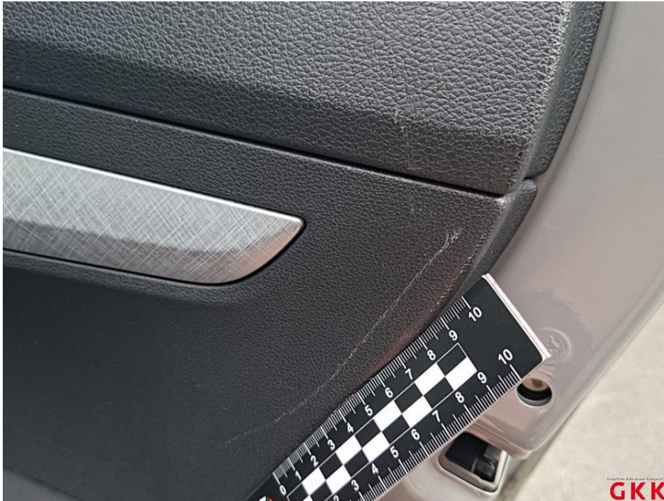
Bild 27. Tür hinten rechts, Innenverkleidung -Standard-, verkratzt, Smartrepair
