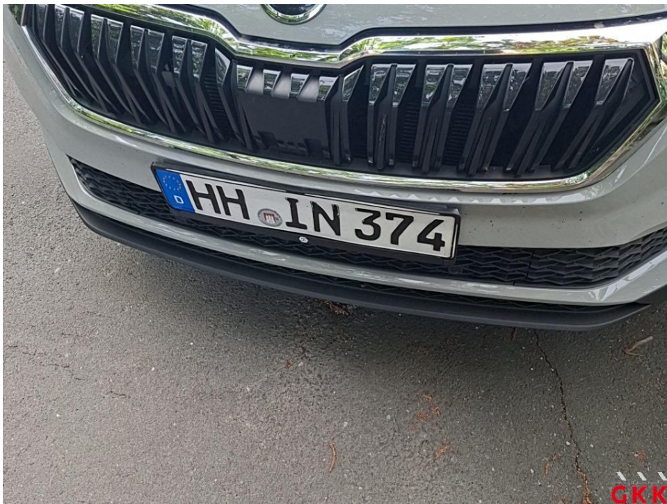
Bild 24. Kennzeichen vorne, Halter, beschädigt, ersetzen
