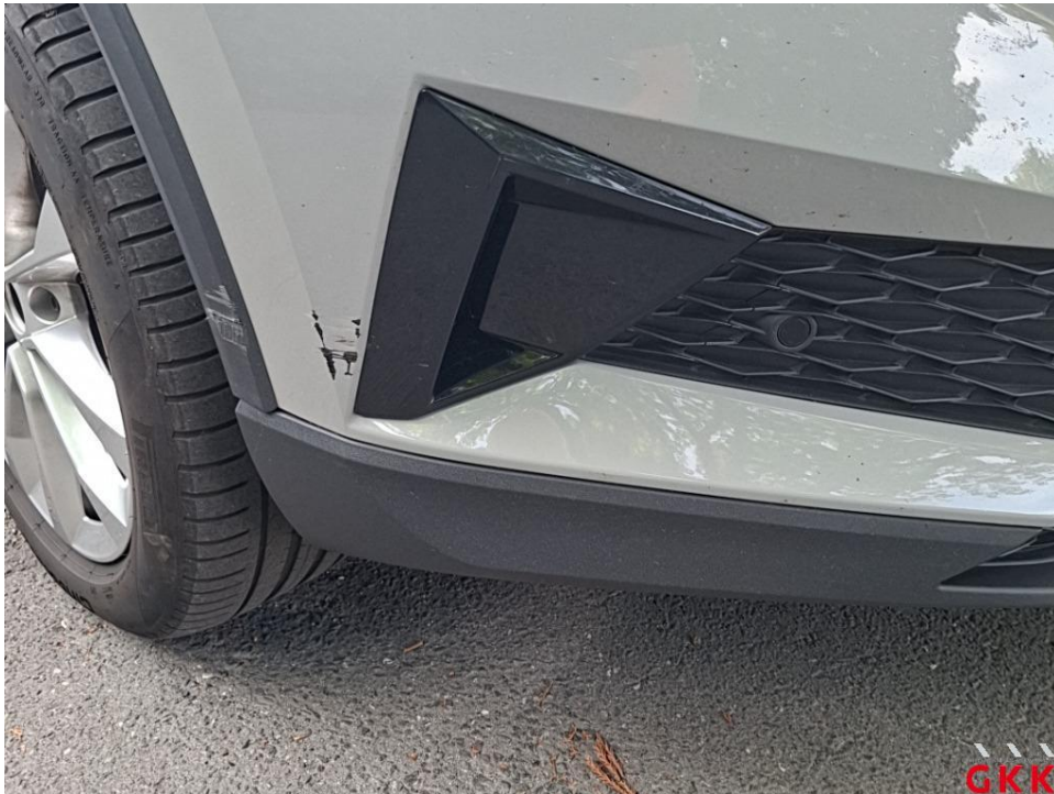
Bild 22. Stoßfänger vorne, Blende -unlackiert-, verkratzt, ersetzen
