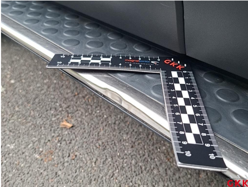
Bild 17. Schweller rechts, Trittbrett, beschädigt, ersetzen
