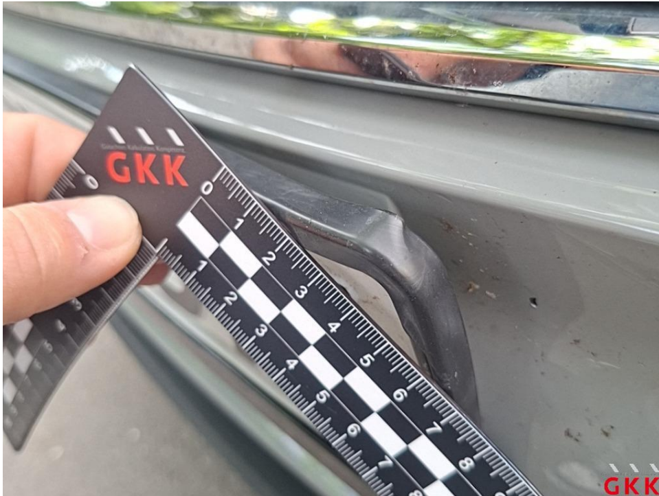
Bild 25. Kennzeichen vorne, Halter, beschädigt, ersetzen
