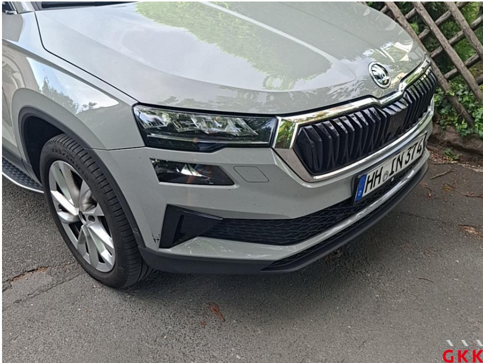
Bild 18. Stoßfänger vorne, Verkleidung oberhalb -lackiert-, verkratzt, lackieren
