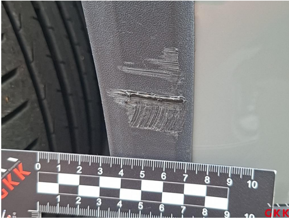
Bild 21. Stoßfänger vorne, Leiste, Radlauf, verkratzt, ersetzen
