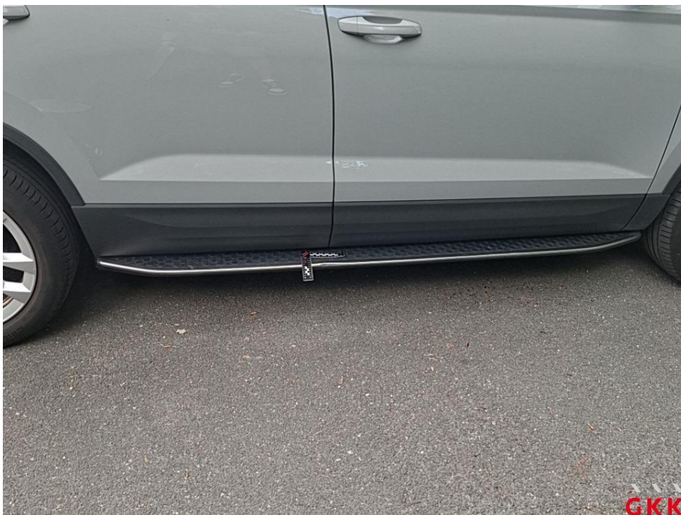
Bild 15. Schweller rechts, Trittbrett, beschädigt, ersetzen
