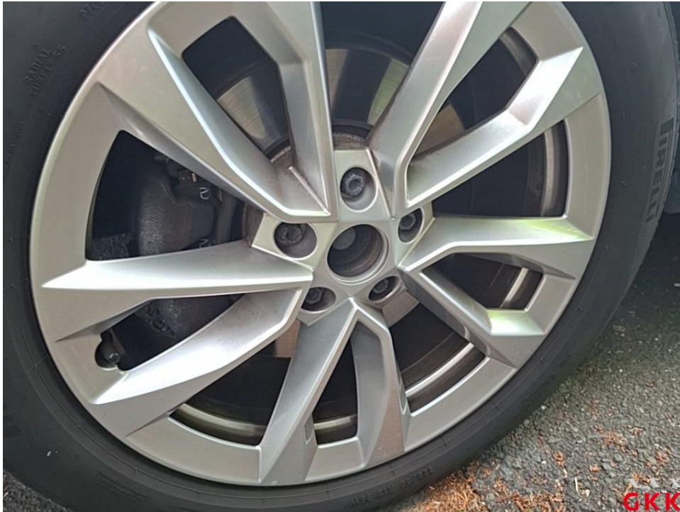
Bild 31. Nabenkappe, Satz, fehlt, ersetzen
