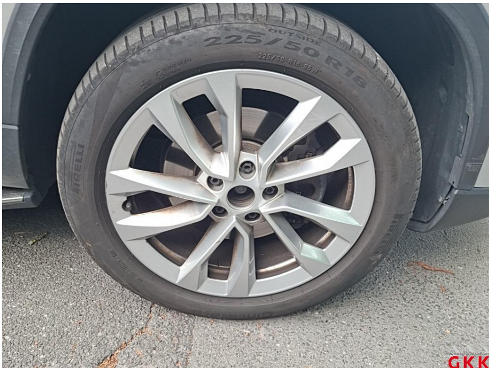
Bild 32. Nabenkappe, Satz, fehlt, ersetzen
