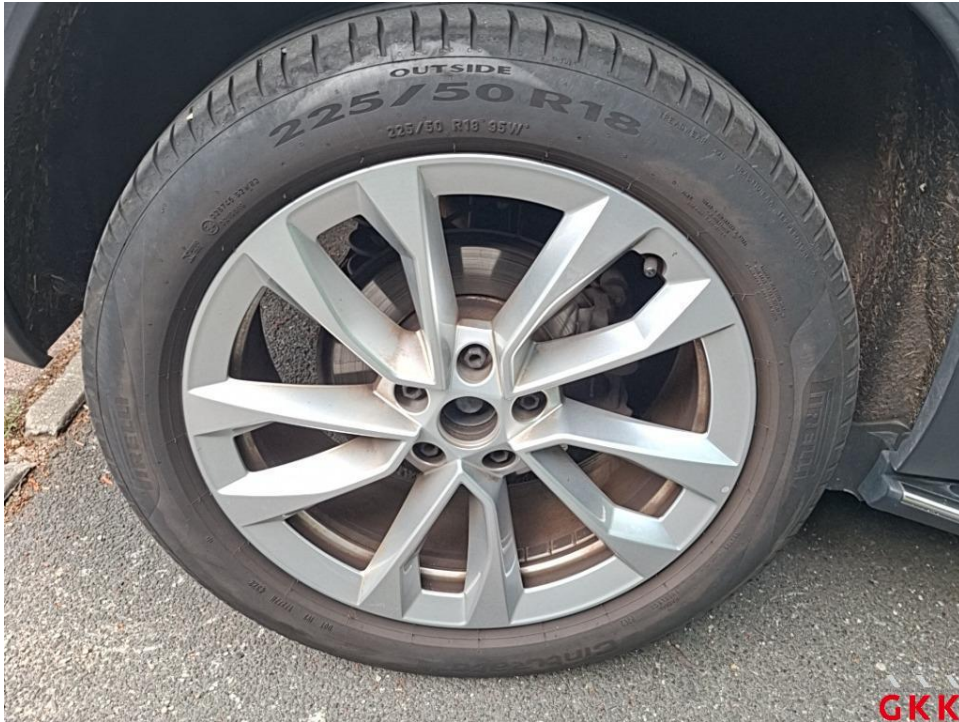
Bild 33. Nabenkappe, Satz, fehlt, ersetzen
