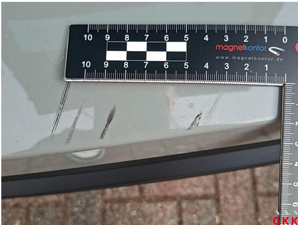
Bild 30. Stoßfänger hinten, Verkleidung oberhalb -lackiert-, verkratzt, lackieren
