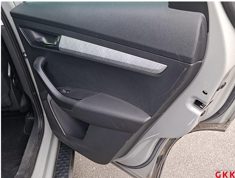
Bild 26. Tür hinten rechts, Innenverkleidung -Standard-, verkratzt, Smartrepair
