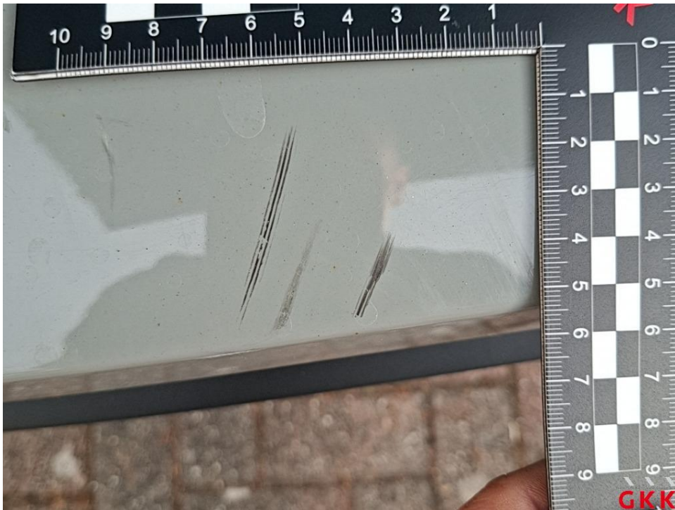
Bild 29. Stoßfänger hinten, Verkleidung oberhalb -lackiert-, verkratzt, lackieren
