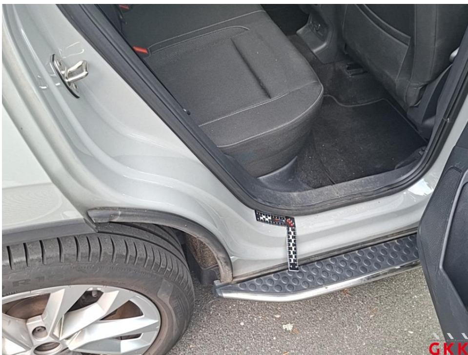
Bild 12. Tür hinten rechts, Einstieg, beschädigt, instand setzen - lackieren
