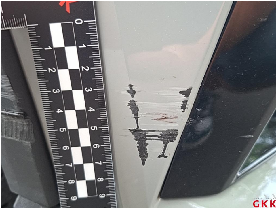
Bild 19. Stoßfänger vorne, Verkleidung oberhalb -lackiert-, verkratzt, lackieren
