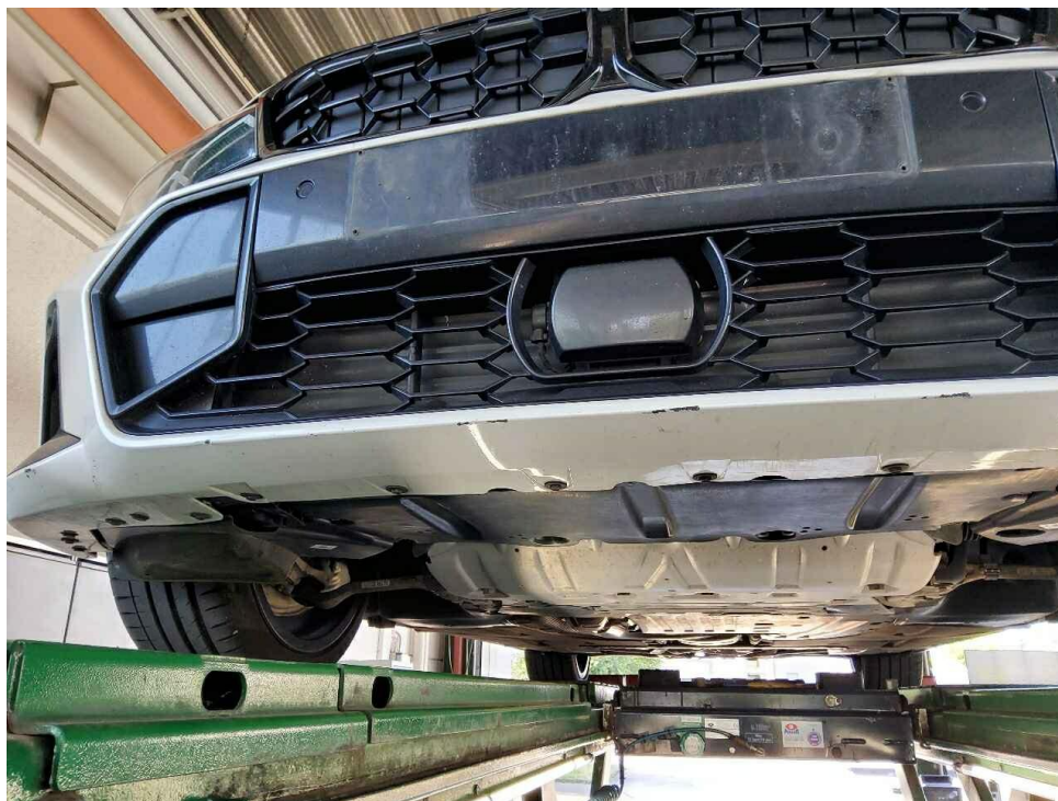
Bild 24 : Stoßfänger vorn mehrfach verschrammt
