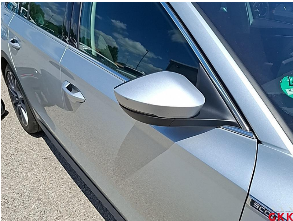
Bild 30. Spiegelgehäuse rechts, Kappe -lackiert-, beschädigt, ersetzen
