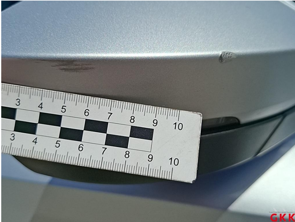
Bild 31. Spiegelgehäuse rechts, Kappe -lackiert-, beschädigt, ersetzen
