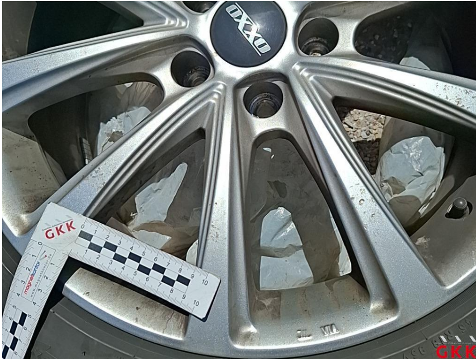
Bild 21. LM-Rad, 1 x beiliegend, beschädigt, Smartrepair
