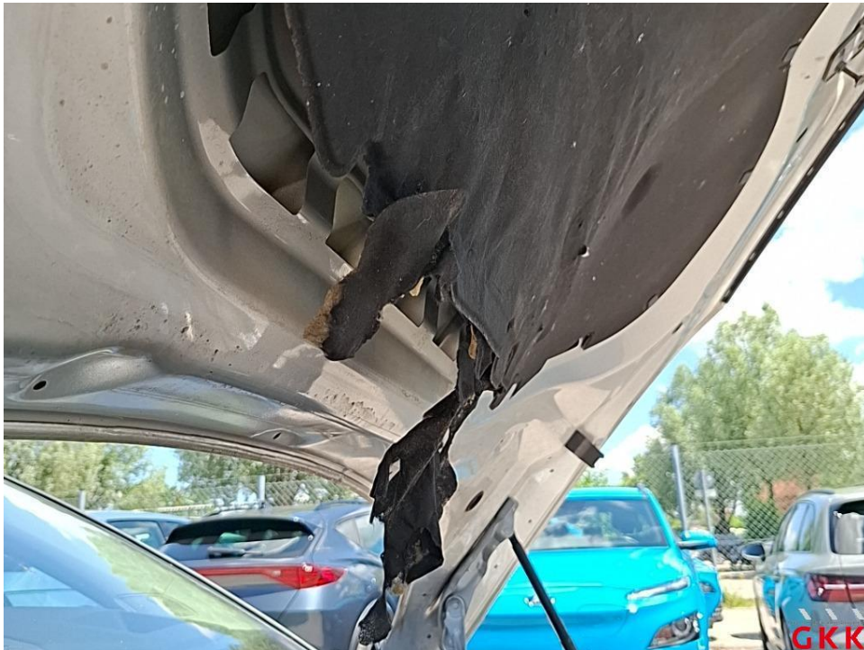
Bild 14. Motorhaube, Dämmmatte, beschädigt, ersetzen
