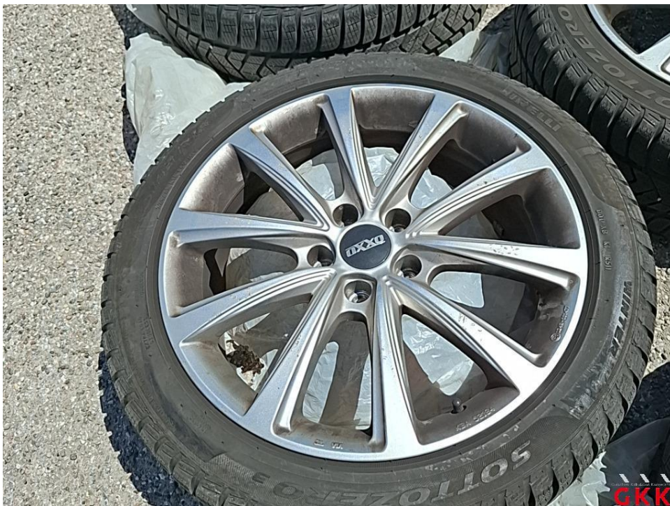
Bild 18. LM-Rad, 1 x beiliegend, beschädigt, Smartrepair
