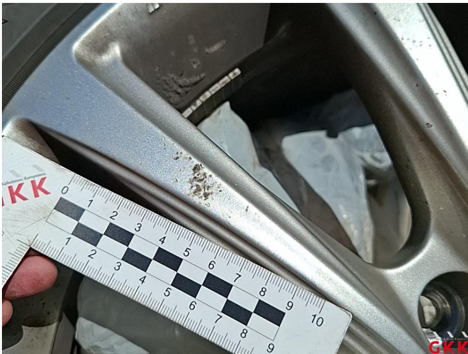
Bild 16. LM-Rad, 1 x beiliegend, beschädigt, Smartrepair
