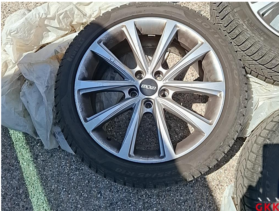
Bild 22. LM-Rad, 1 x beiliegend, beschädigt, Smartrepair
