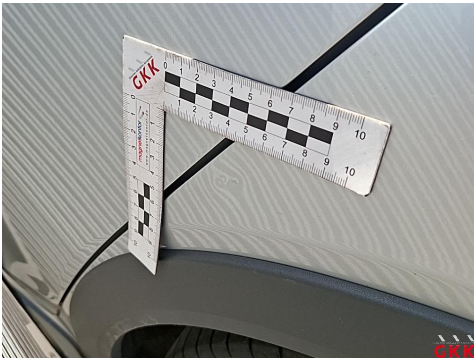
Bild 28. Seitenwand links, bis 3 Dellen / Bauteil, instand setzen - lackieren
