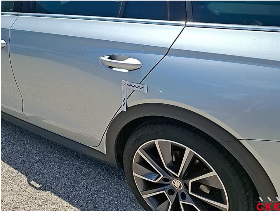
Bild 27. Seitenwand links, bis 3 Dellen / Bauteil, instand setzen - lackieren
