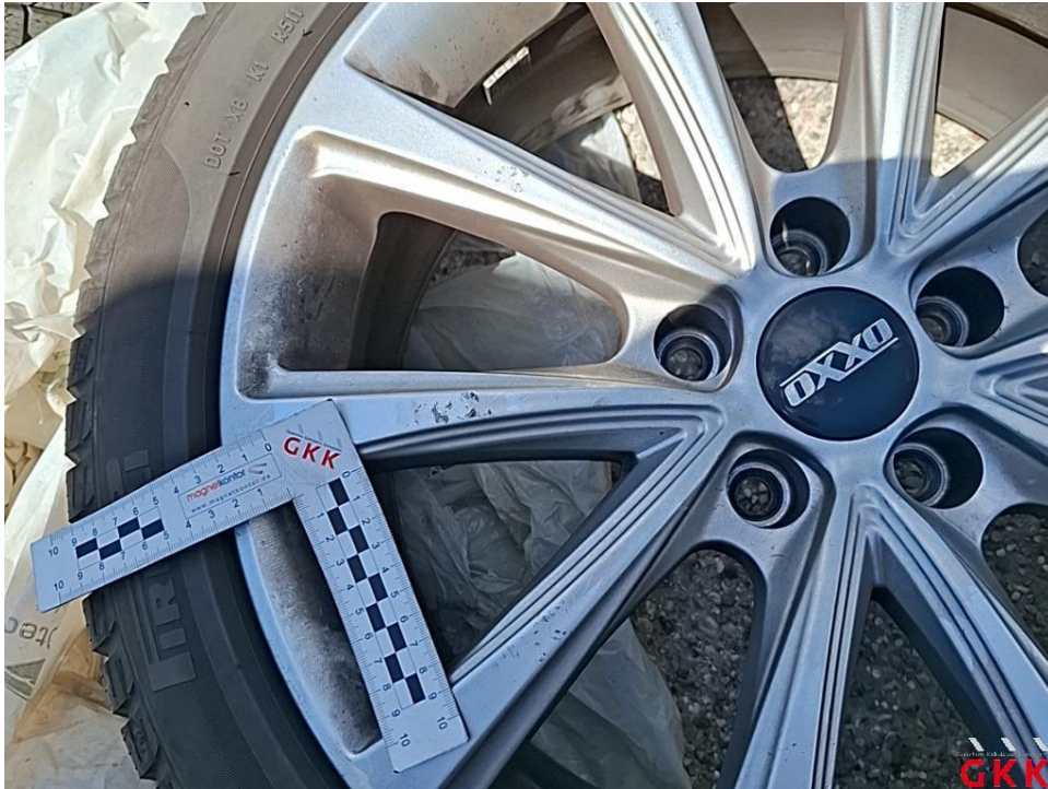
Bild 23. LM-Rad, 1 x beiliegend, beschädigt, Smartrepair
