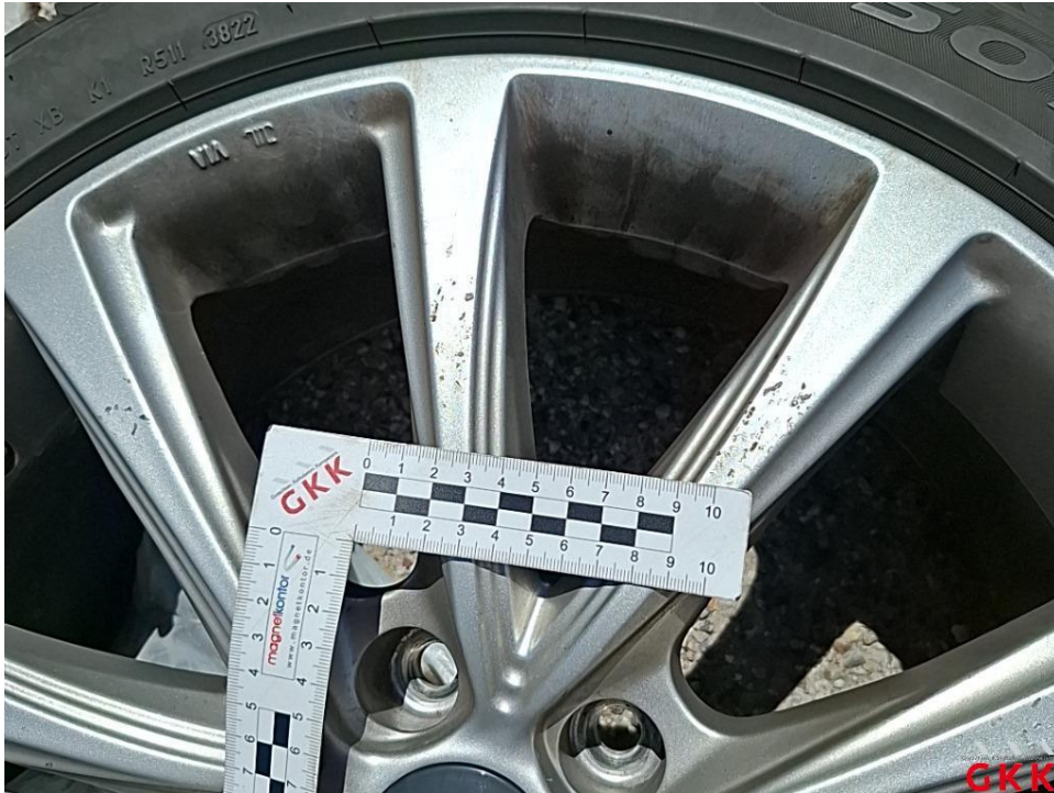
Bild 17. LM-Rad, 1 x beiliegend, beschädigt, Smartrepair
