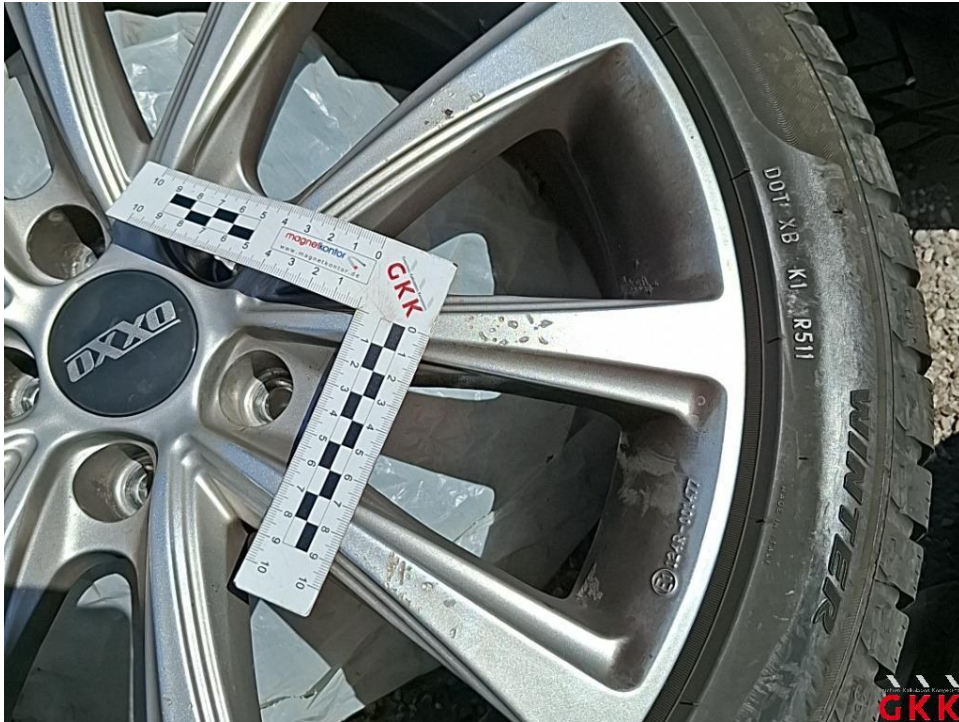
Bild 19. LM-Rad, 1 x beiliegend, beschädigt, Smartrepair
