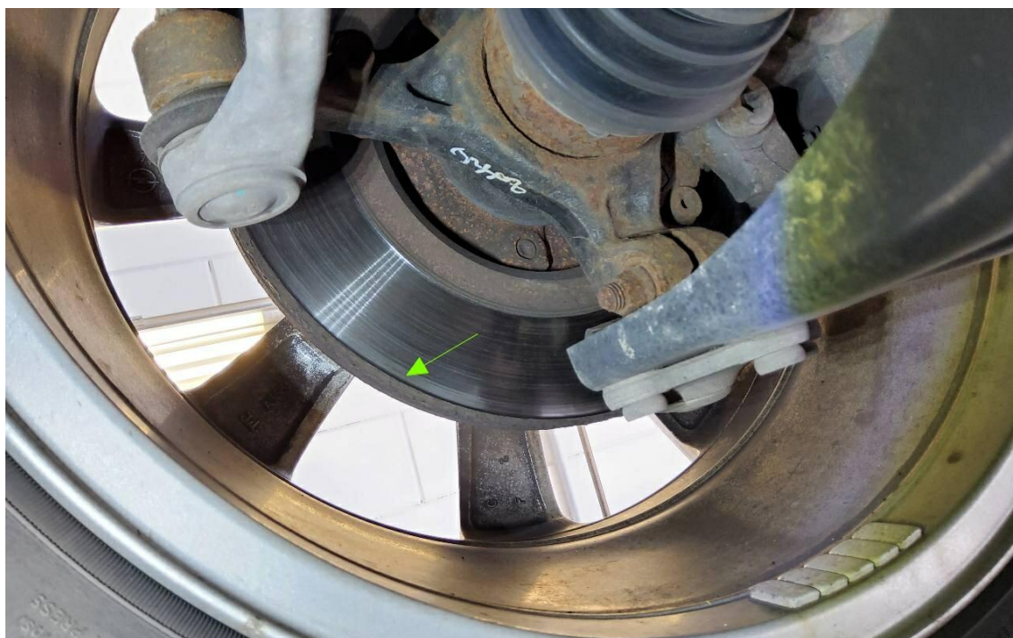
Bild 18 : T- Bremsscheiben Vorderachse eingelaufen
