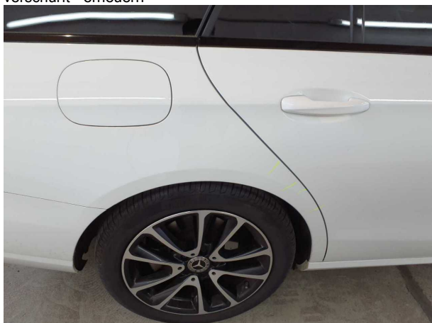
Beschädigung #2: Seitenwand rechts: Seitenwand - Delle(n) - Smart Repair
