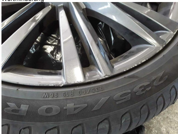
Beschädigung #5: 2.Radsatz: 1 Leichtmetallfelge - verkratzt / verschürft - Wertminderung
