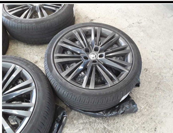
Beschädigung #5: 2.Radsatz: 1 Leichtmetallfelge - verkratzt / verschürft - Wertminderung
