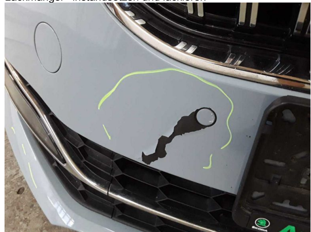
Beschädigung #7: Stossfänger vorn: Stossfänger vorn - Lackmangel - instandsetzen und lackieren
