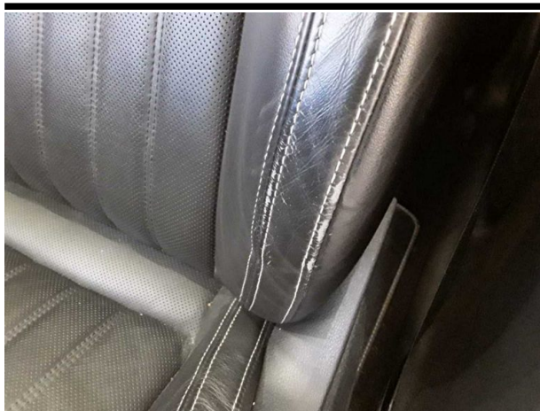
Beschädigung #4: Sitz vorn: Sitzbezug links - porös / rissig - Wertminderung
