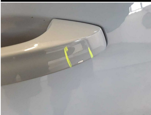
Beschädigung #6: Tür vorn rechts: Griff außen - verkratzt / verschürft - Smart Repair
