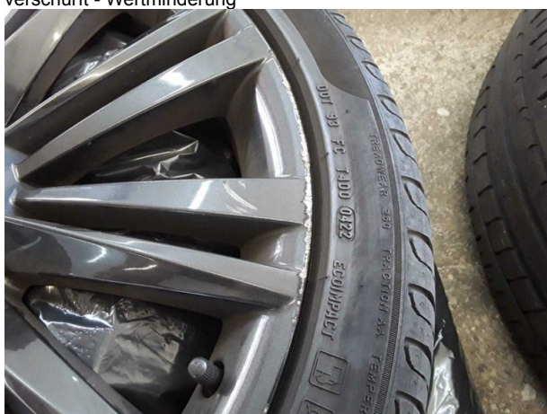
Beschädigung #5: 2.Radsatz: 1 Leichtmetallfelge - verkratzt / verschürft - Wertminderung
