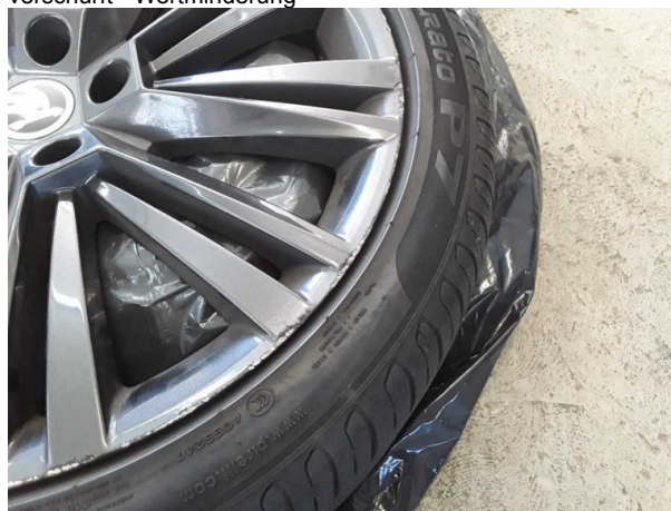
Beschädigung #5: 2.Radsatz: 1 Leichtmetallfelge - verkratzt / verschürft - Wertminderung
