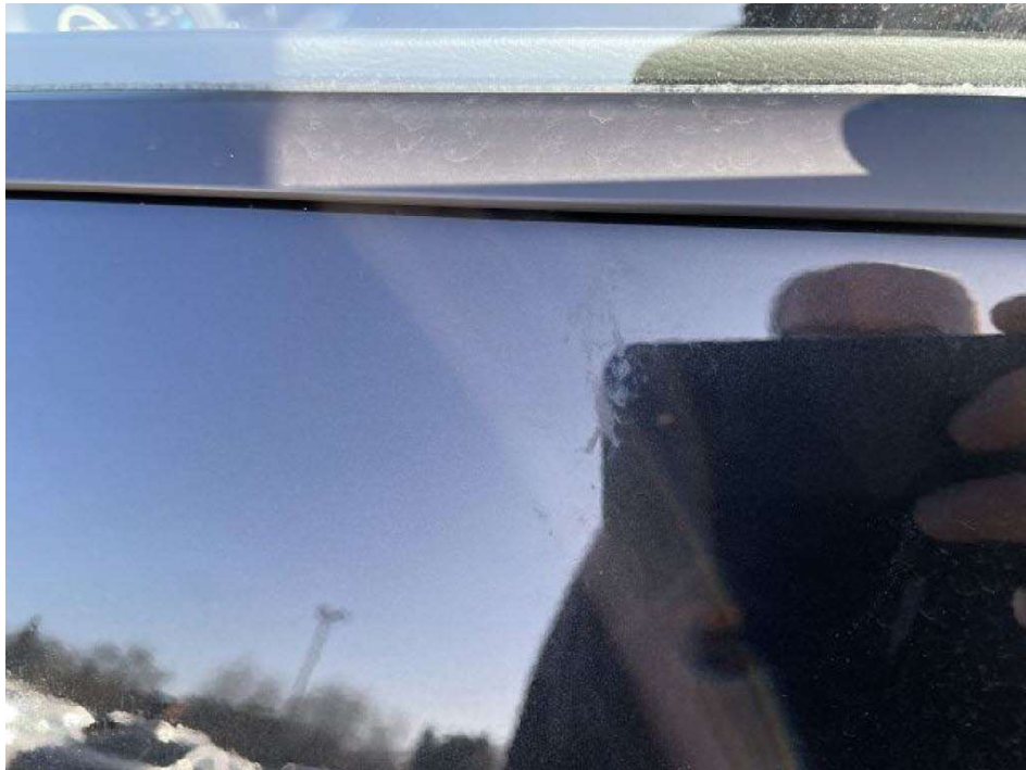
Bild 13 Tür Vorne Links - Vogelkotverätzung
