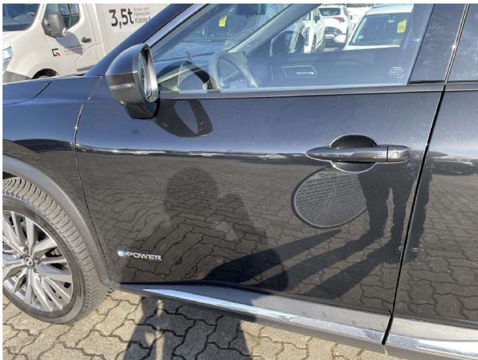
Bild 12 Tür Vorne Links - Vogelkotverätzung
