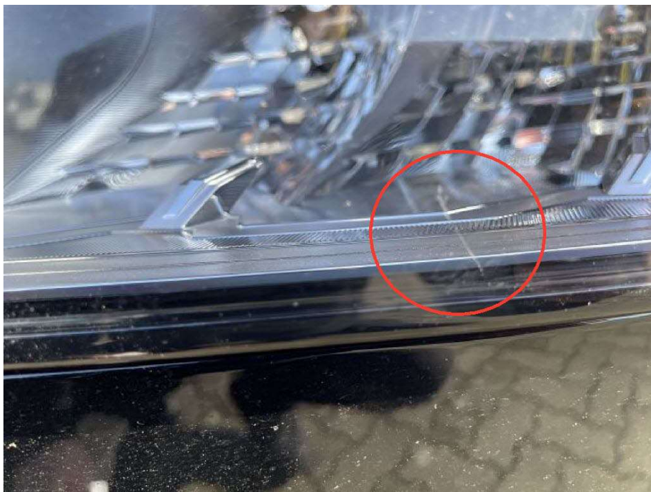
Bild 8 Scheinwerfer Links - Kratzer
