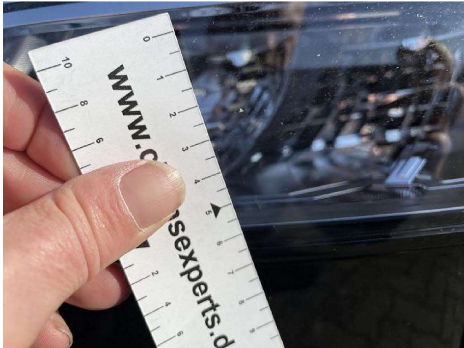
Bild 9 Scheinwerfer Links - Kratzer
