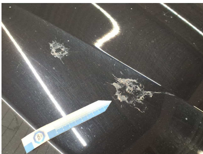
Damage 5: Bonnet: Bonnet (Verätzung) - Soiled - Paint
