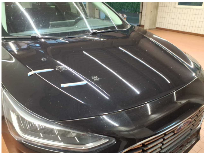
Damage 5: Bonnet: Bonnet (Verätzung) - Soiled - Paint
