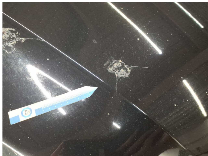
Damage 5: Bonnet: Bonnet (Verätzung) - Soiled - Paint
