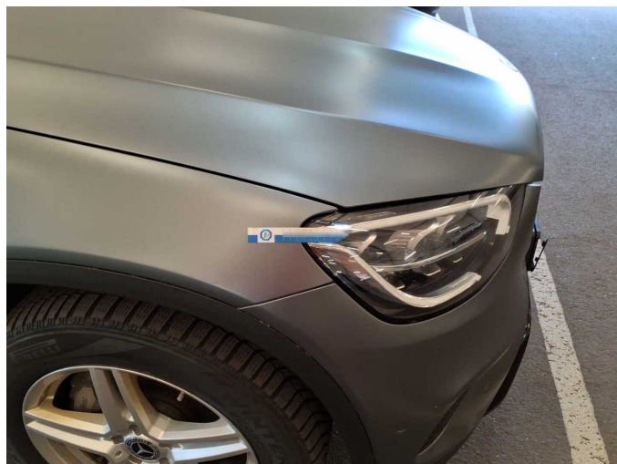
Damage 6: Headlight: Headlight - right side (Außerhalb des Leuchtbereichs) - Scratch(es) - Loss in value
