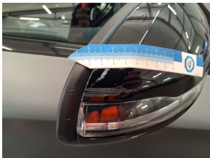
Damage 4: Wing mirror - right side: Cap (Mit Materialabtrag) - Scratched - Paint
