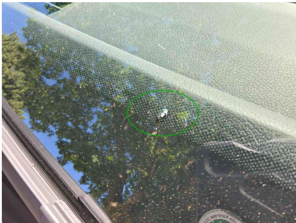
Bild 17 : Windschutzscheibe Steinschlag mit Rissbildung
