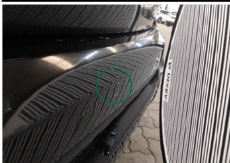
Stoßfänger / Hinten / Delle
