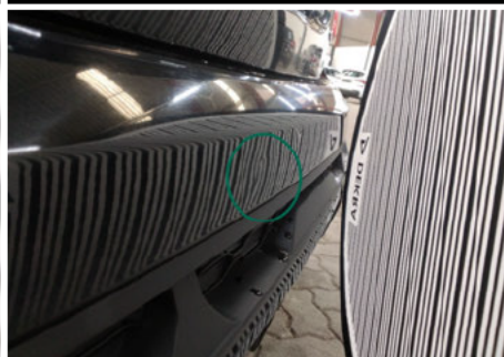
Stoßfänger / Hinten / Delle
