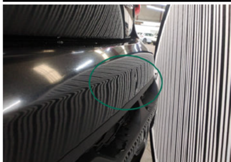
Stoßfänger / Hinten / Delle
