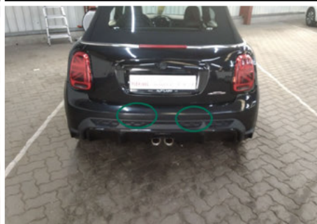
Stoßfänger / Hinten / Delle
