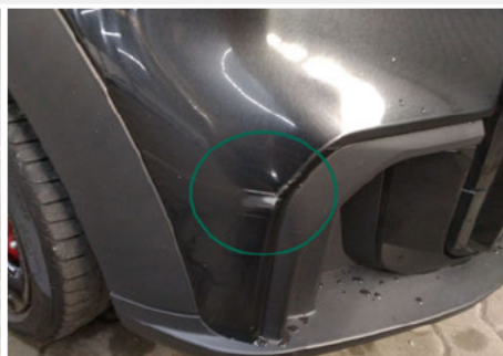
Stoßfänger / Vorne Rechts / Kratzer
