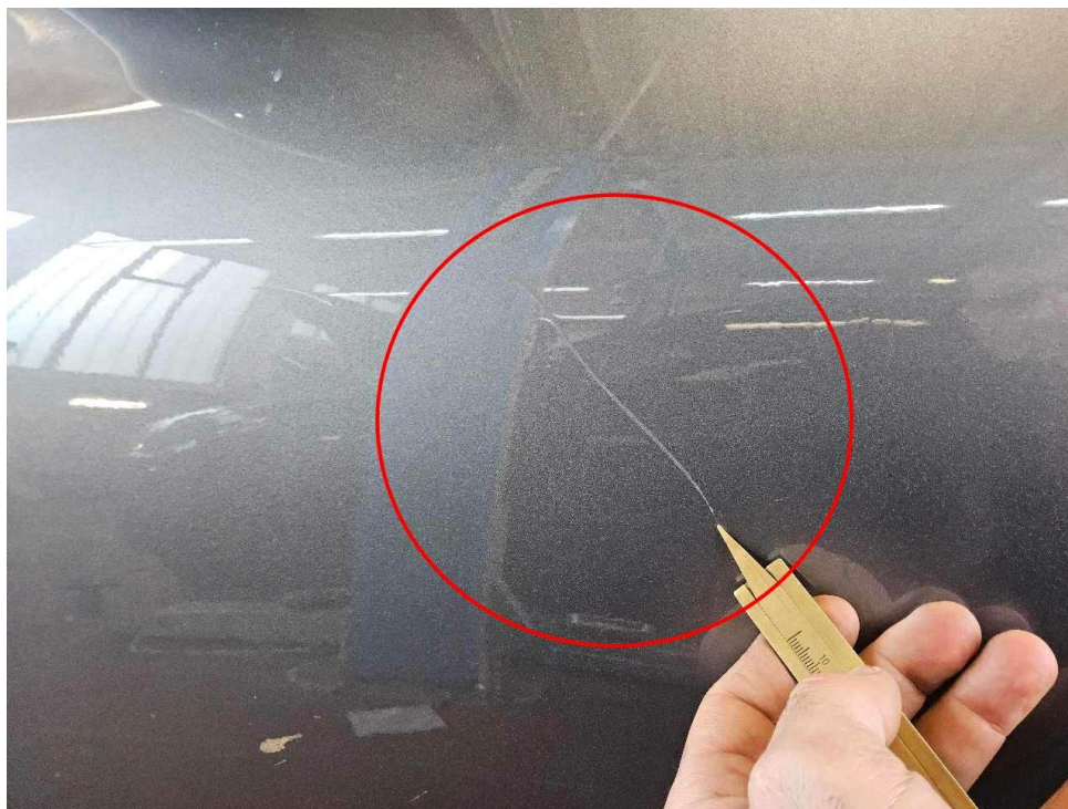
Bild 12 : Tür vorn links verschrammt
