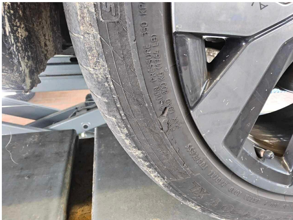
Bild 18 : Reifen vorn rechts eingerissen und verschlissen
