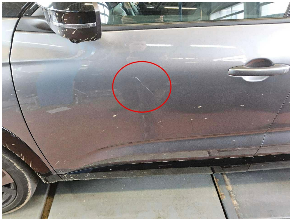
Bild 11 : Tür vorn links verschrammt
