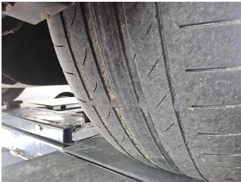
Bild 20 : Reifen vorn rechts eingerissen und verschlissen
