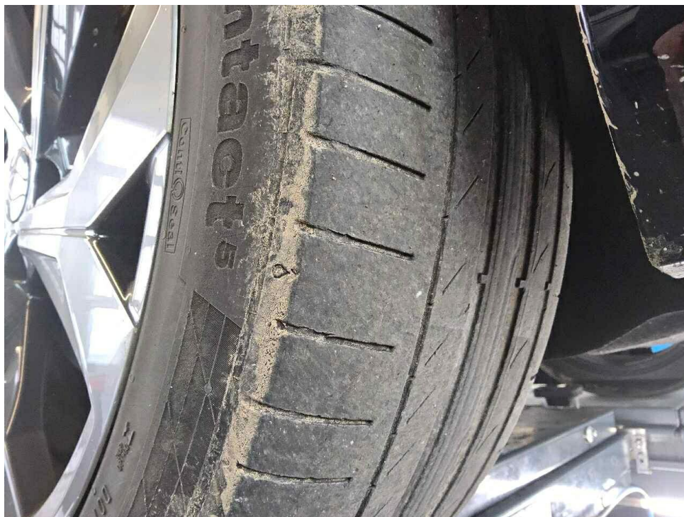
Bild 19 : Reifen vorn rechts eingerissen und verschlissen
