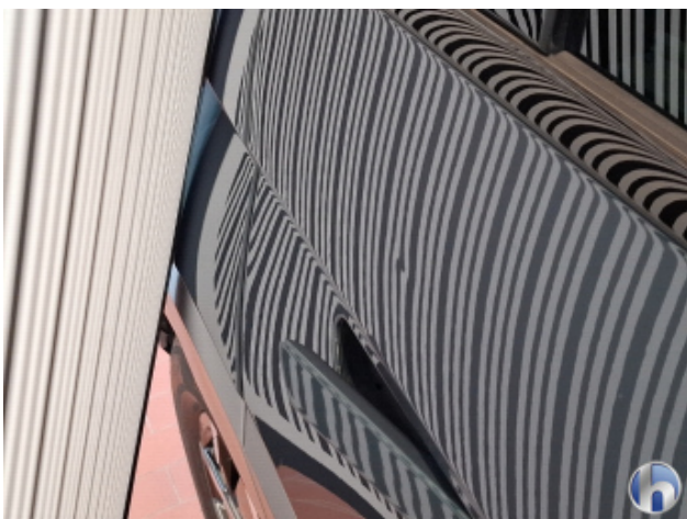
3. Tür Hinten - Rechts 1 Delle - Sanft Instandsetzen
