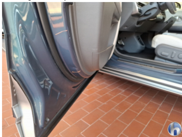
6. Tür Vorne - Links 1 Delle - Sanft Instandsetzen
