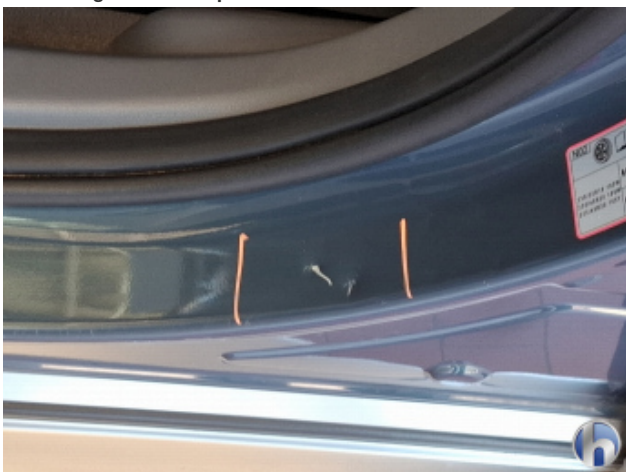
5. Türeinstieg Vorne - Links Beschädigt - Smart Repair
