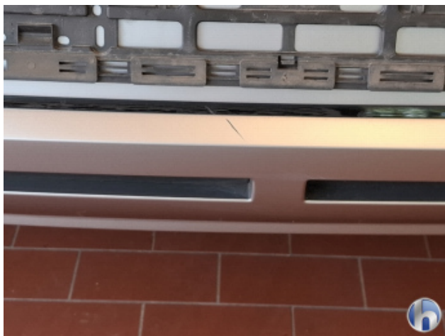
2. Stoßfänger Hinten Kratzer - Smart Repair
