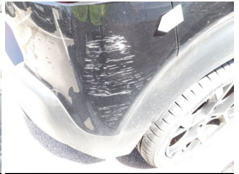
Pare-chocs / Arrière Droit / Rayure
