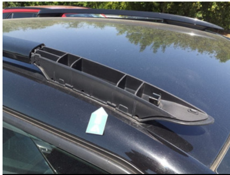
Barre de toit / Droit / Non Conforme
