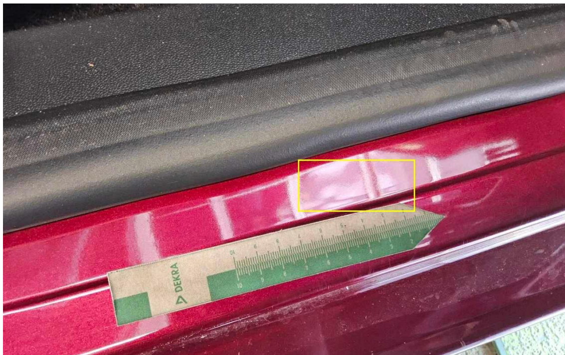
Bild 14 : Tür vorne rechts Einstieg, eingedellt, Gebrauchsspur
