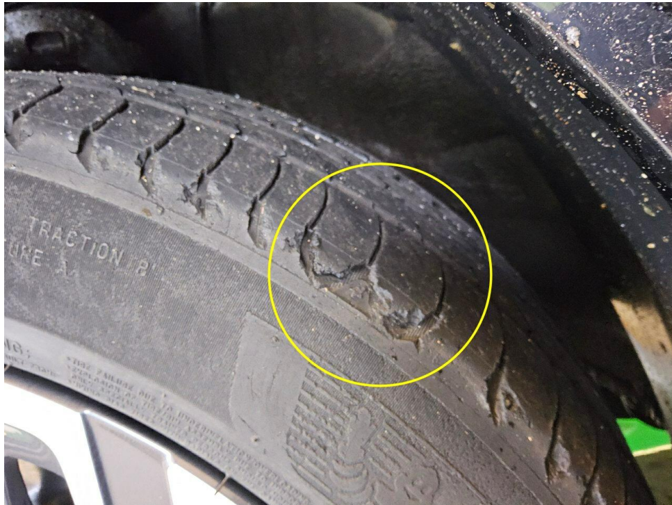
Bild 11 : Reifen an der Vorderachse Profilblöcke lösen sich ab
