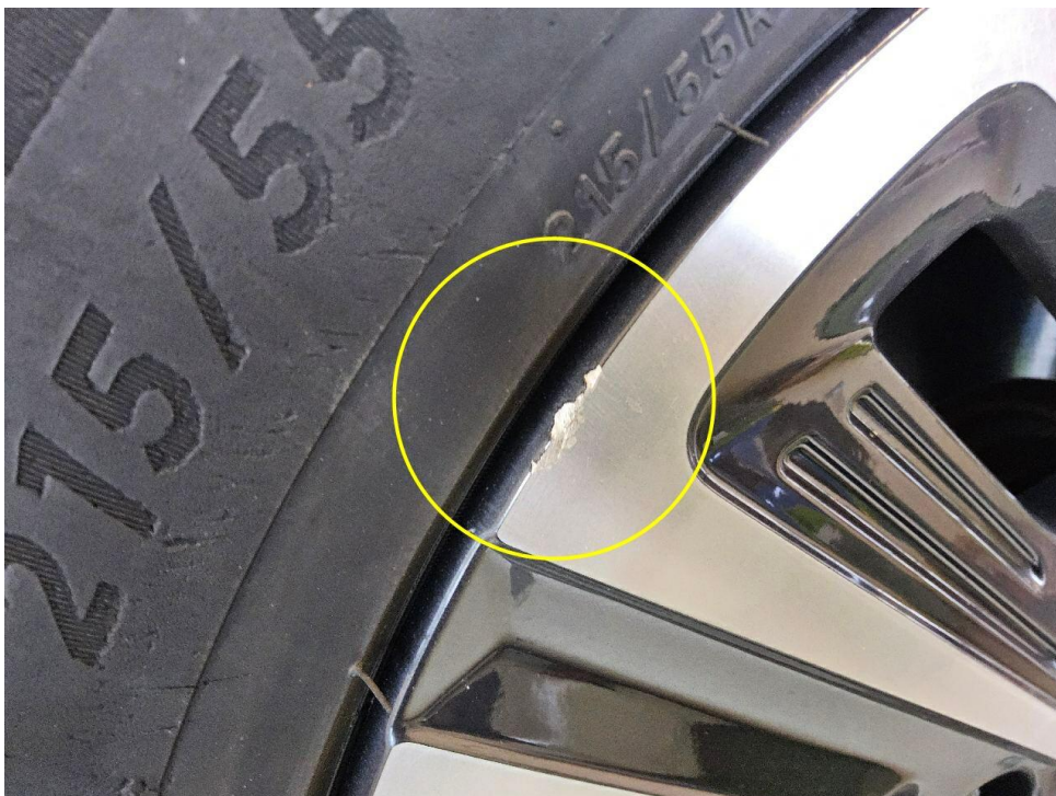
Bild 10 : Alufelge vorne links zerkratzt
