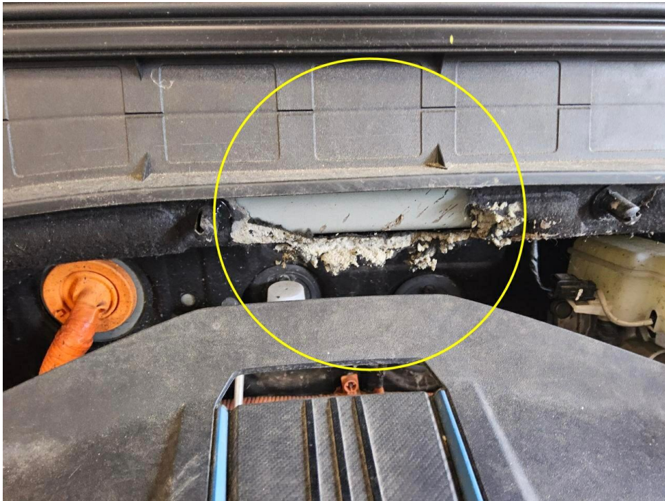
Bild 9 : Motorraum Dämmmatte beschädigt durch Marder
