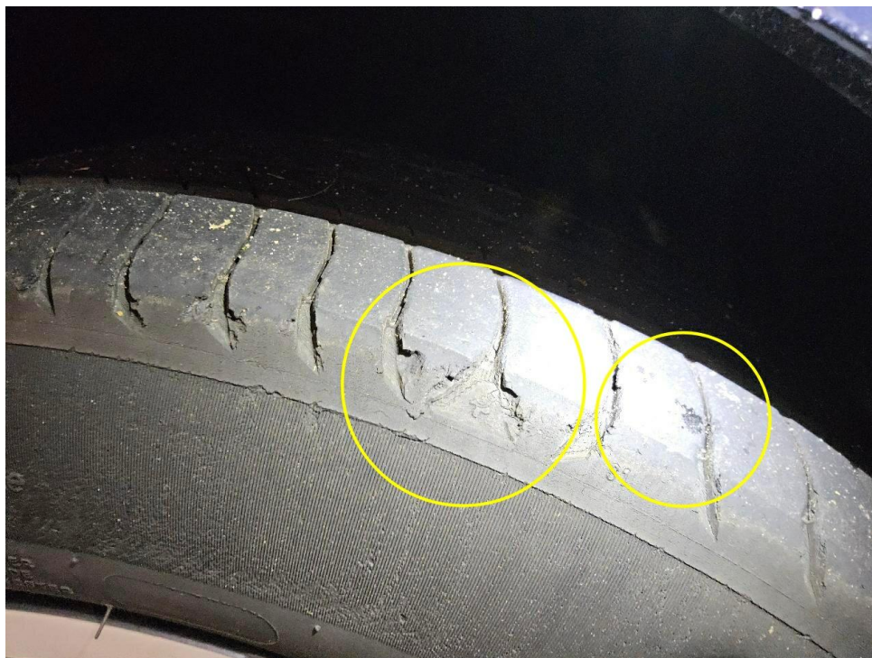
Bild 13 : Reifen an der Vorderachse Profilblöcke lösen sich ab
