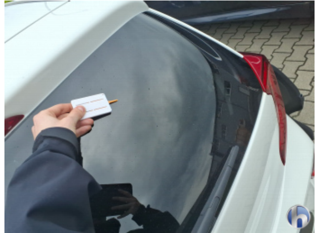
10. Fenster Außen hinten Kratzer - Erneuern
