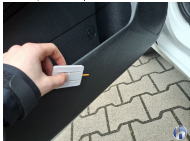
9. Verkleidung Kratzer - Smart Repair
