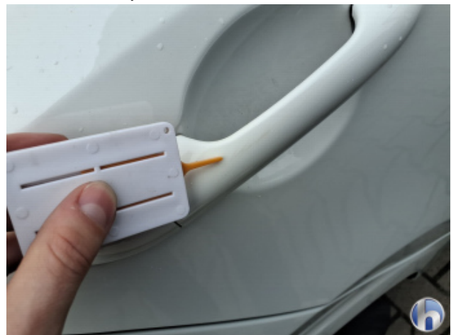
5. Außentürgriff Hinten - Rechts Kratzer - Smart Repair
