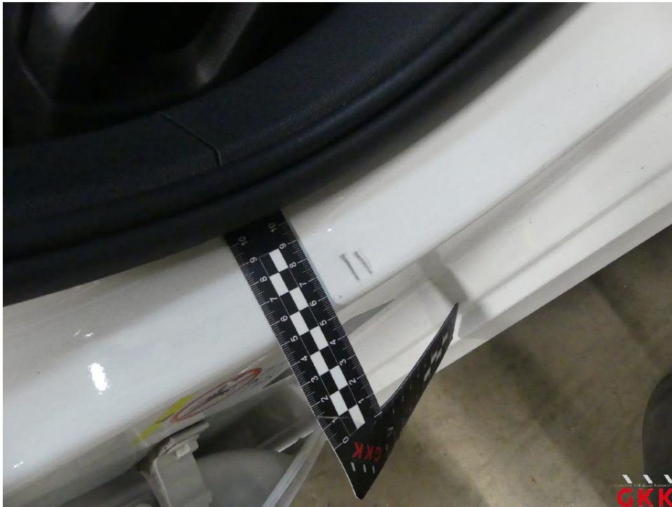
Bild 21 Tür hinten rechts, Einstieg, beschädigt, Smartrepair
