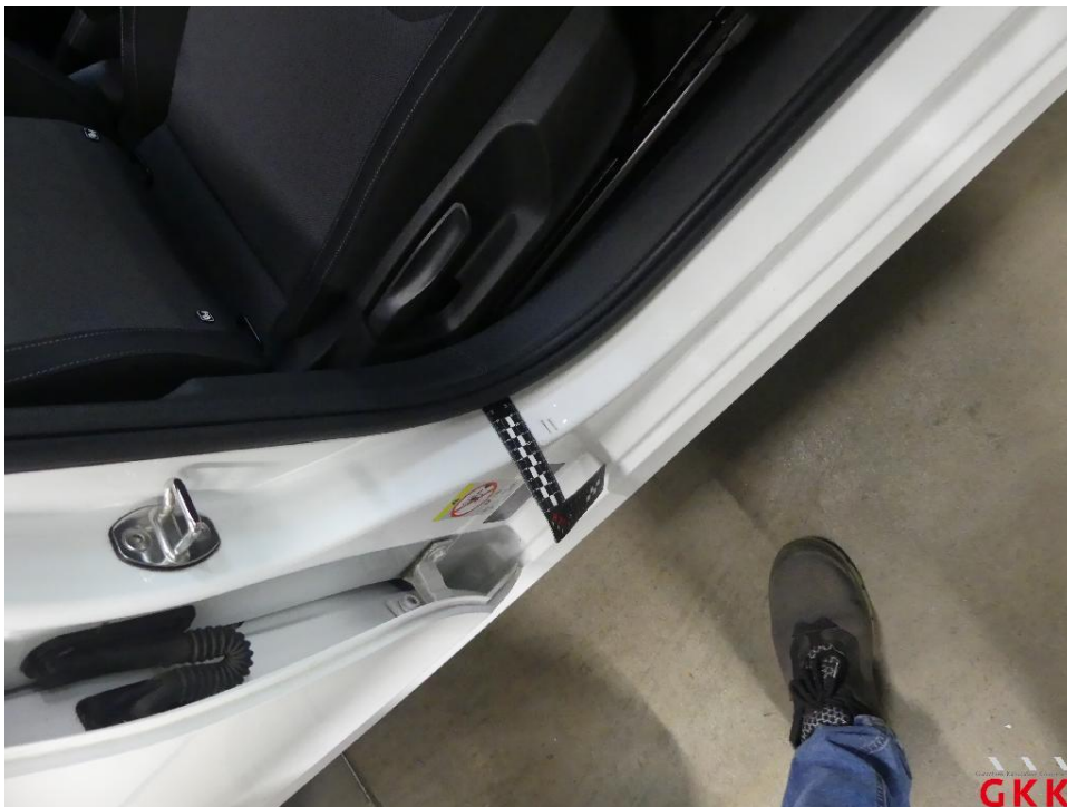
Bild 20 Tür hinten rechts, Einstieg, beschädigt, Smartrepair
