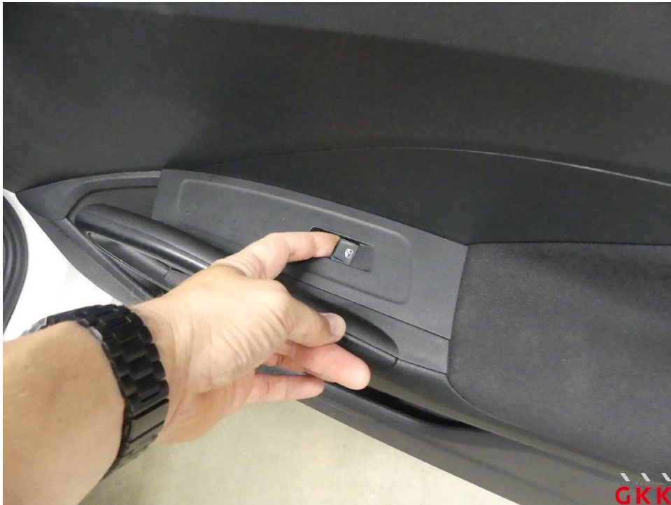
Bild 25 Tür vorne rechts, Fensterheber, funktionsuntüchtig, ersetzen
