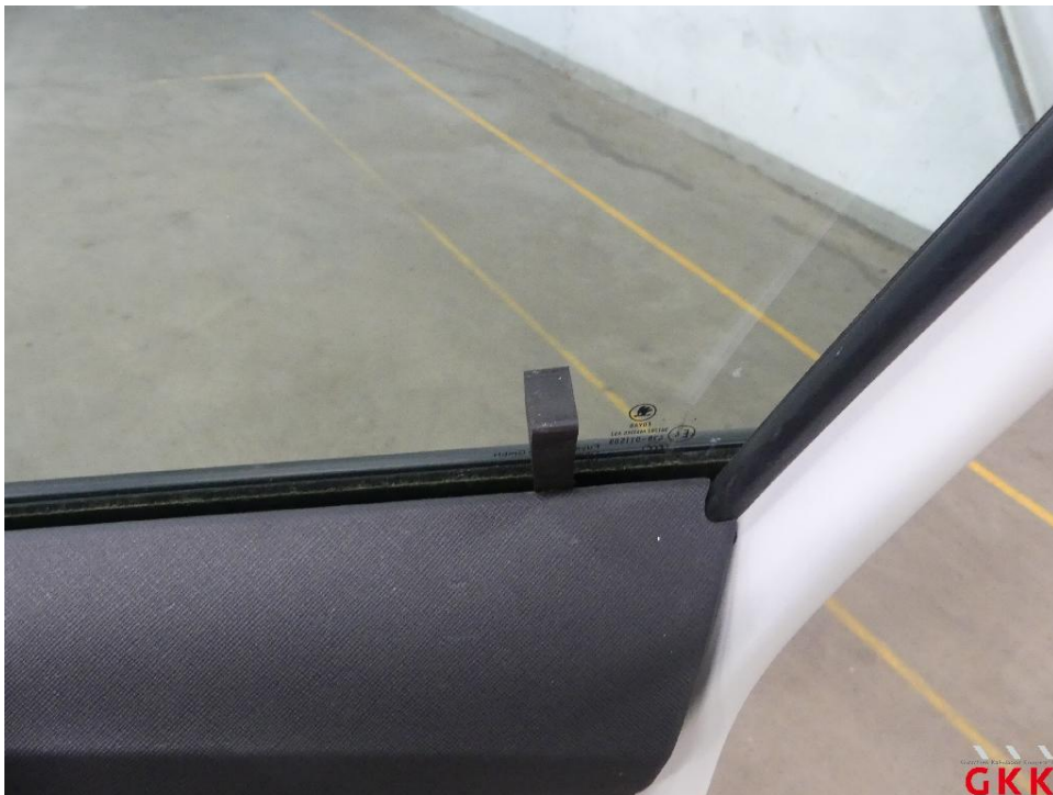
Bild 24 Tür vorne rechts, Fensterheber, funktionsuntüchtig, ersetzen
