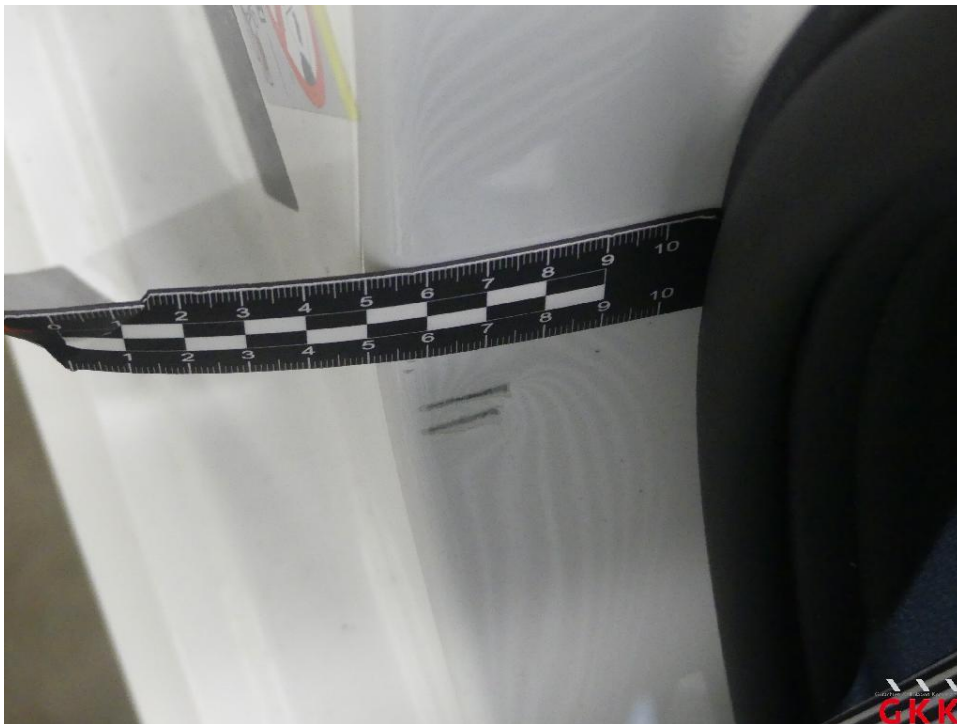
Bild 22 Tür hinten rechts, Einstieg, beschädigt, Smartrepair
