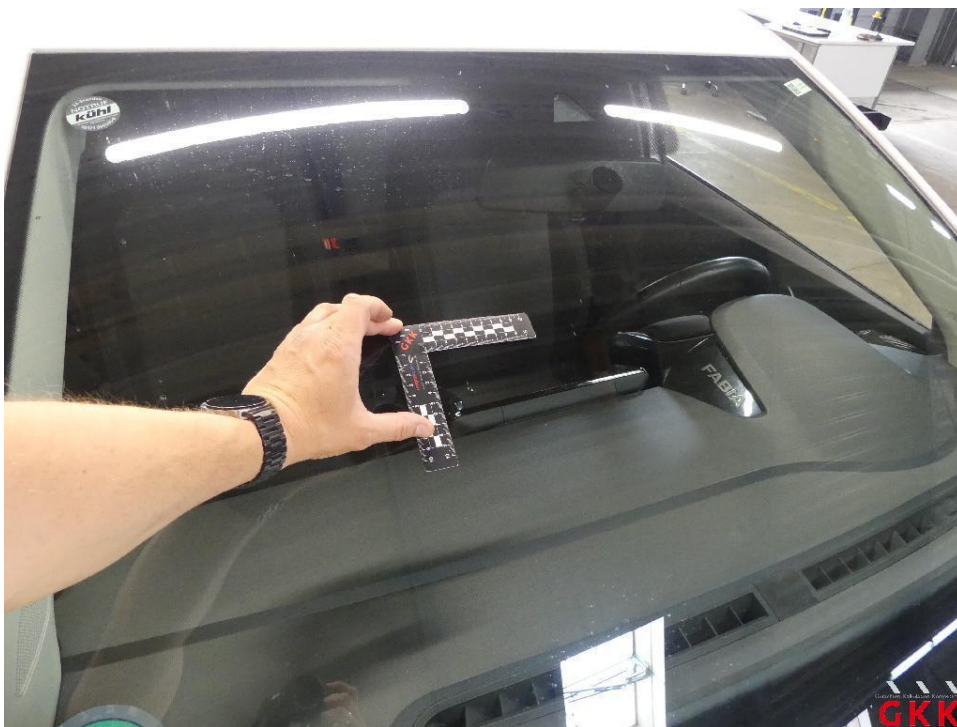
Bild 14 Frontscheibe, Steinschlag mit Rissbildung, instand setzen
