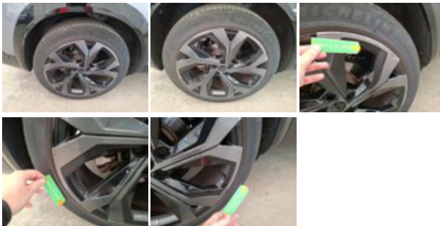
Pneu ARD, Déchirure, E - Remplacer
