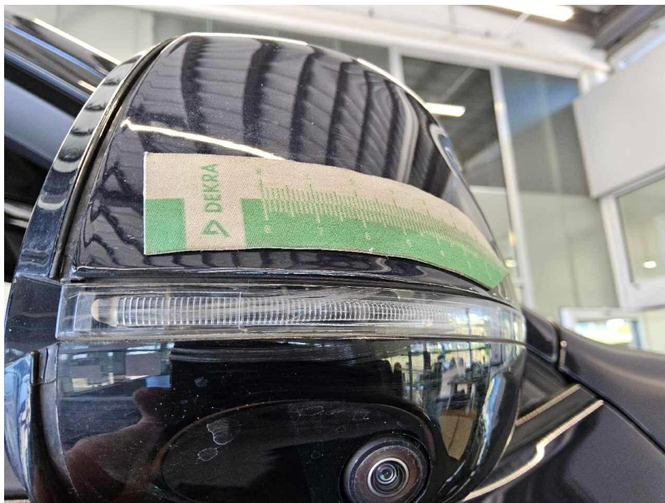
Bild 15 : Außenspiegel Kappe und Blinker rechts verschrammt
