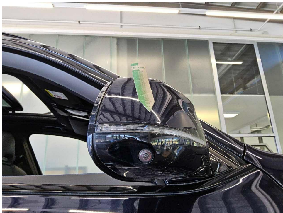
Bild 14 : Außenspiegel Kappe und Blinker rechts verschrammt
