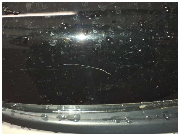
Beschädigung #1: Außenspiegel rechts: Abdeckkappe - Kratzer - Smart Repair
