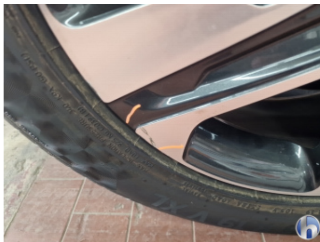
3. Felge Hinten - Rechts Beschädigt - Smart Repair
