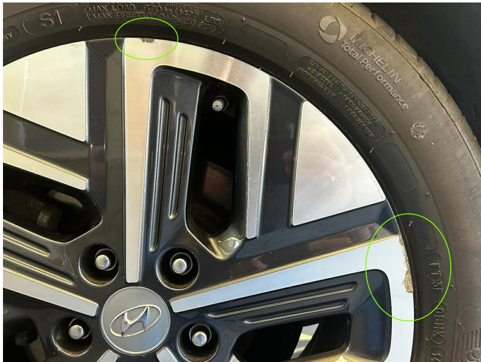
Bild 15 : Felge hinten rechts verschrammt, glanzgedreht
