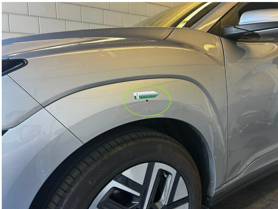
Bild 8 : Kotflügel vorne links Zierleiste Lackierung, verschrammt, smart repair
