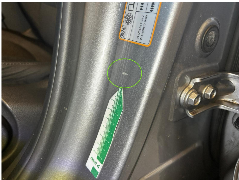
Bild 12 : Tür vorne links Einstieg Lackierung, zerkratzt, smart repair
