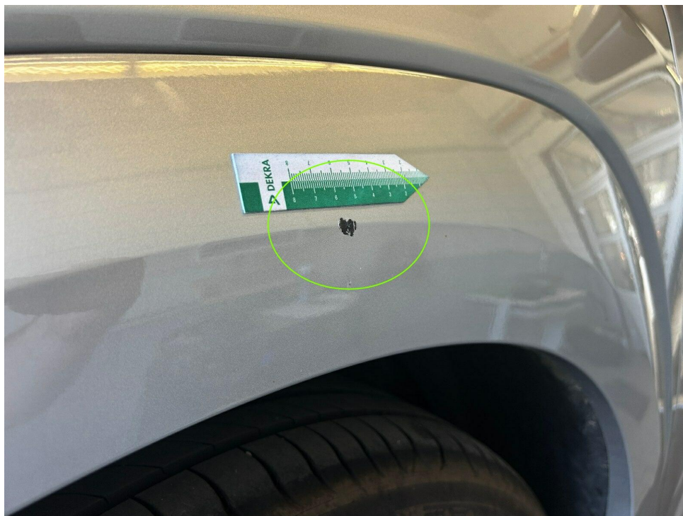
Bild 9 : Kotflügel vorne links Zierleiste Lackierung, verschrammt, smart repair
