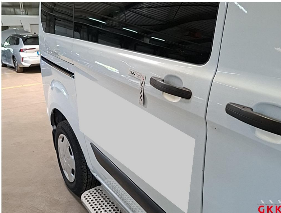
Bild 32 Schiebetür rechts, beschädigt, instand setzen - lackieren
