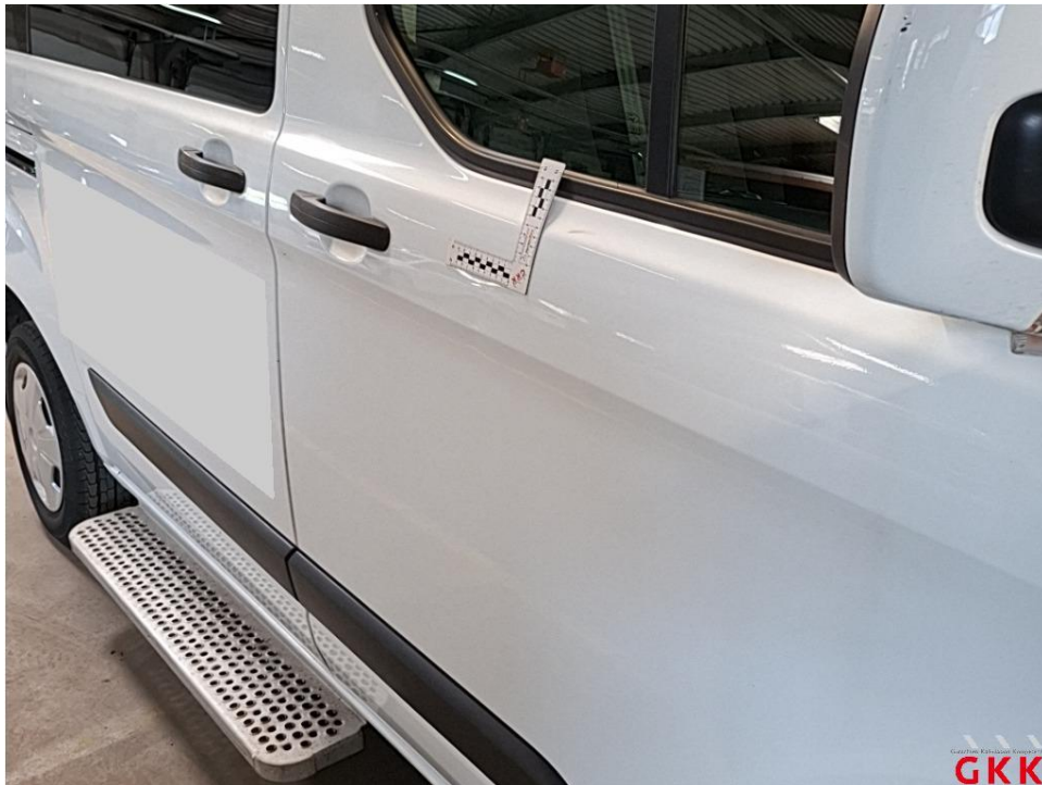
Bild 47 Tür vorne rechts, beschädigt, instand setzen - lackieren
