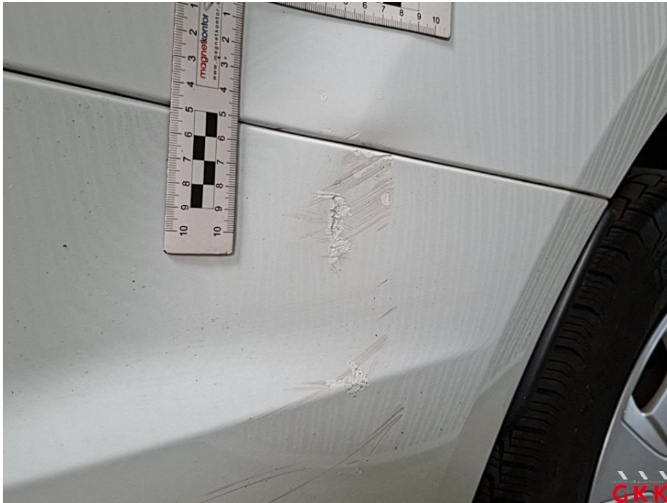
Bild 37 Fahrzeug, Seite rechts, Unfallschaden, Unfallschaden beheben
