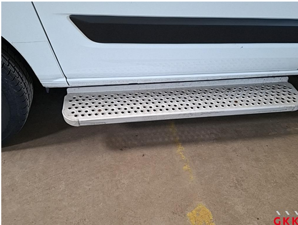
Bild 38 Trittbrett, verkratzt, ersetzen
