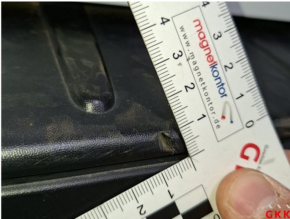
Bild 46 Stoßfänger hinten, Verkleidung -unlackiert-, beschädigt, ersetzen
