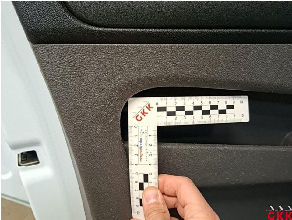
Bild 25 Tür vorne links, Innenverkleidung -Standard-, verkratzt, Smartrepair
