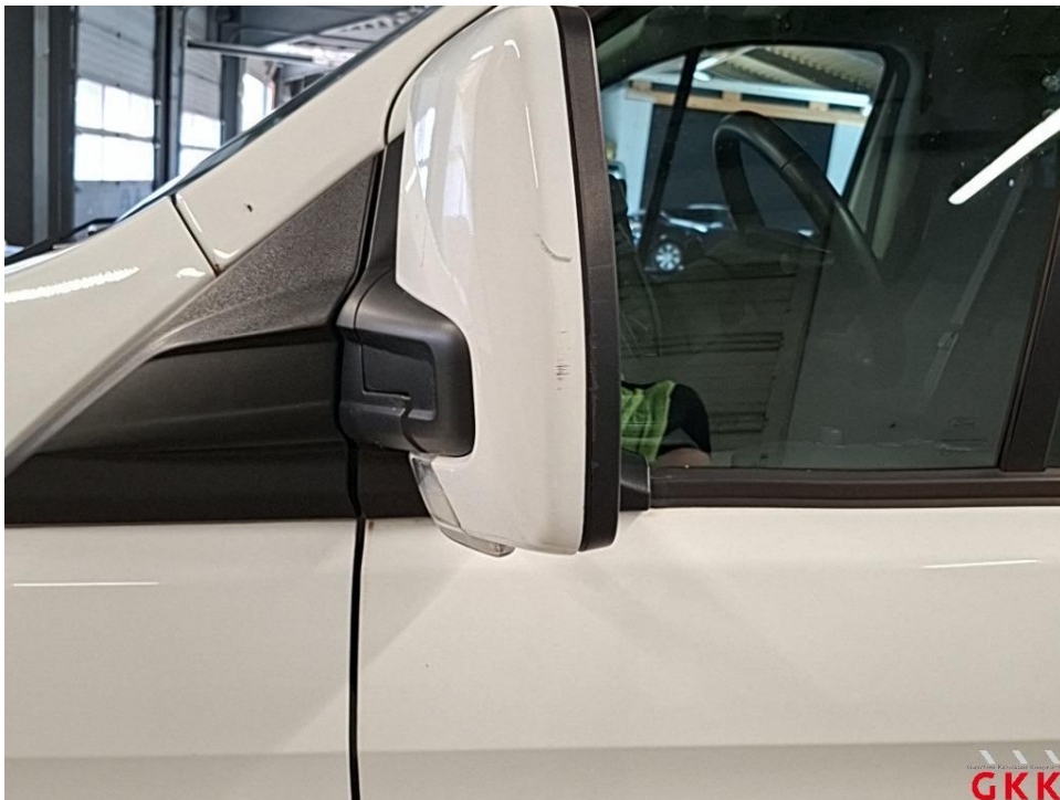
Bild 28 Spiegelgehäuse links, Rahmen, verkratzt, ersetzen
