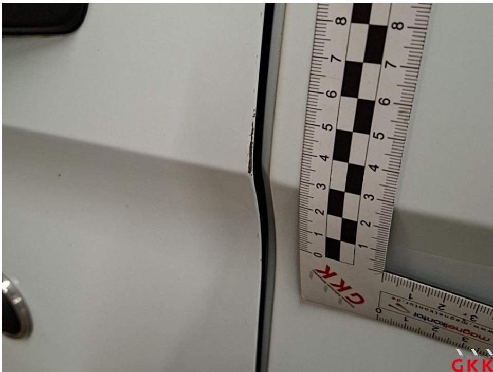
Bild 22 Tür vorne links, Kante, verkratzt, Smartrepair
