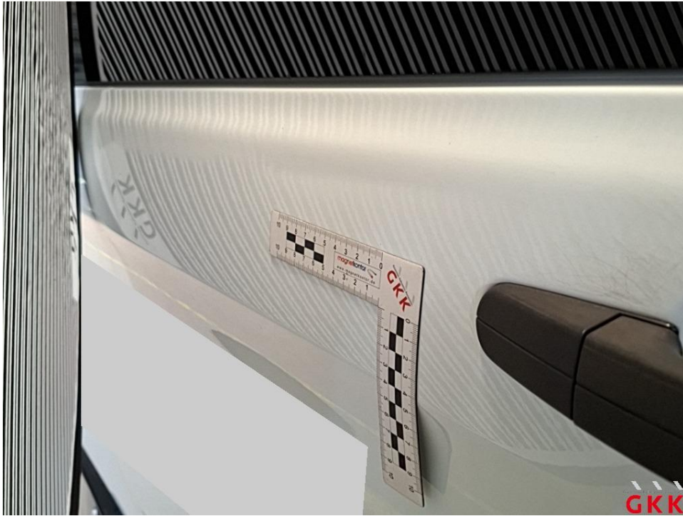
Bild 33 Schiebetür rechts, beschädigt, instand setzen - lackieren
