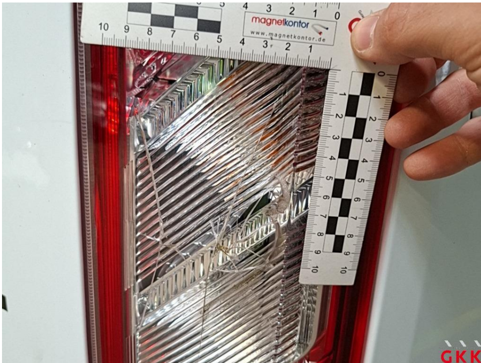
Bild 42 Rückleuchte rechts, außen, beschädigt, ersetzen
