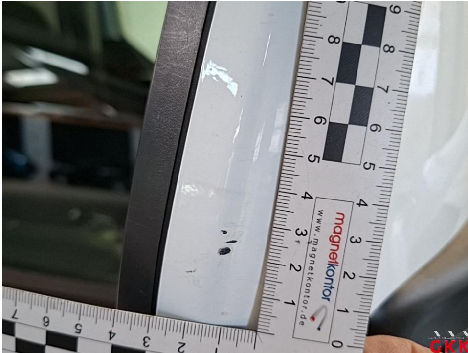
Bild 31 Spiegelgehäuse rechts, Kappe -lackiert-, verkratzt, lackieren ohne LV
