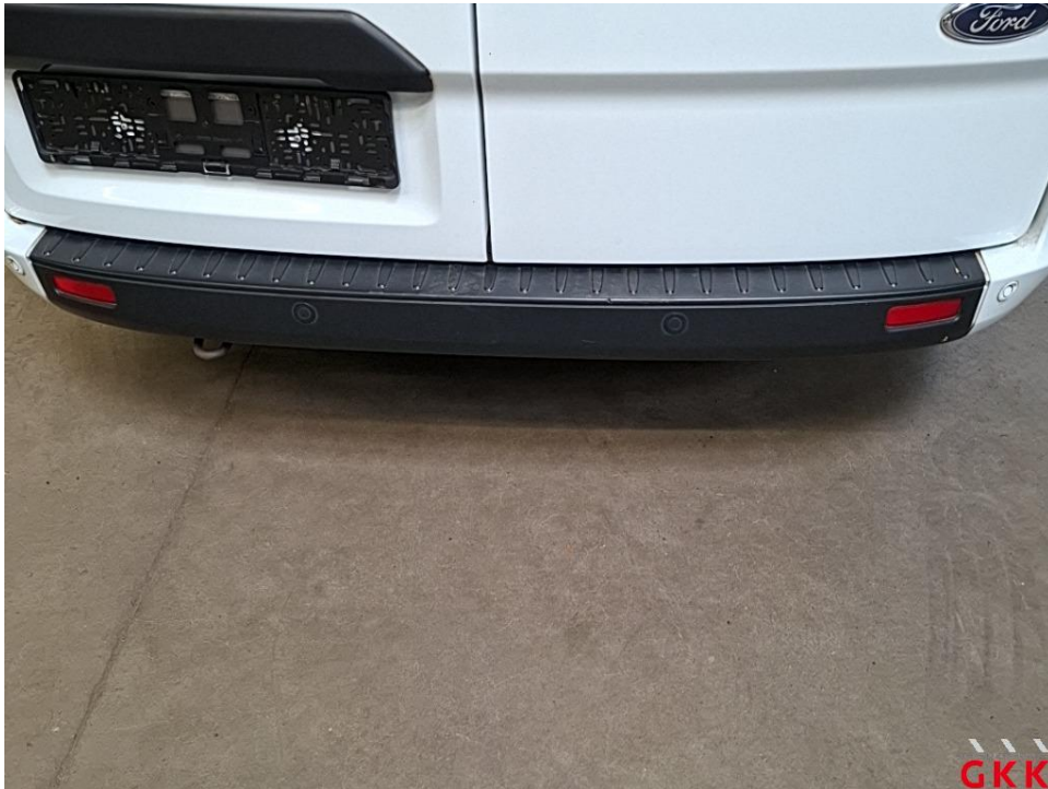
Bild 45 Stoßfänger hinten, Verkleidung -unlackiert-, beschädigt, ersetzen
