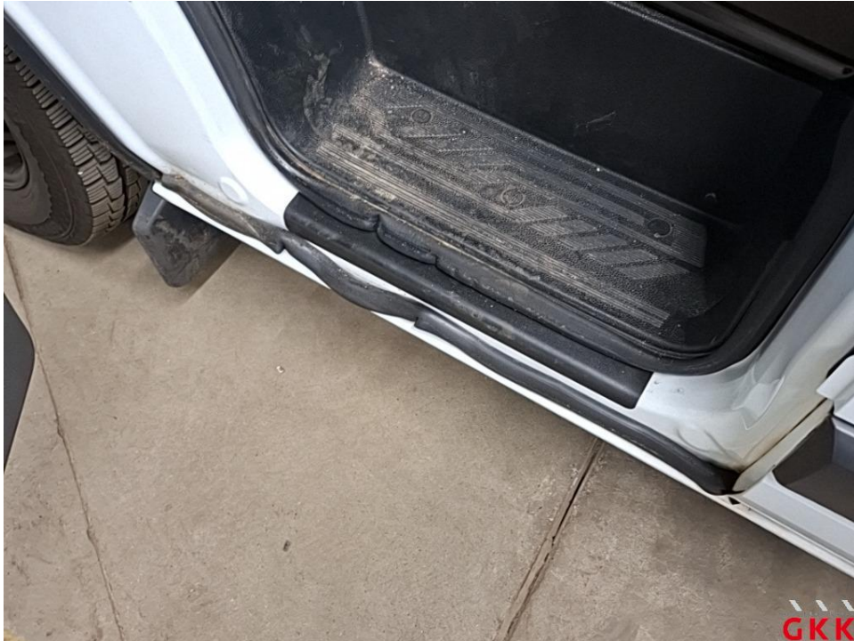
Bild 23 Tür vorne links, Dichtung -Einstieg-, lose, ersetzen
