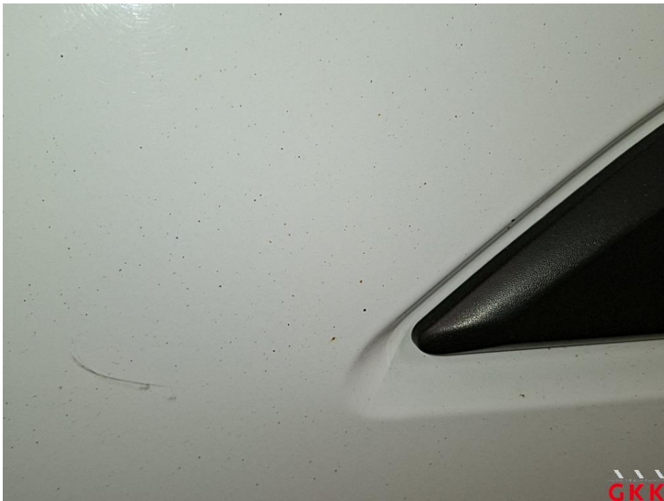
Bild 20 Fahrzeug, außen, Lackierung verwittert / matt, aufbereiten
