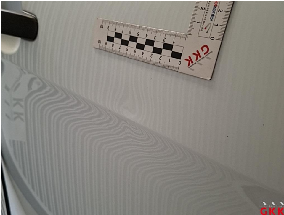
Bild 48 Tür vorne rechts, beschädigt, instand setzen - lackieren
