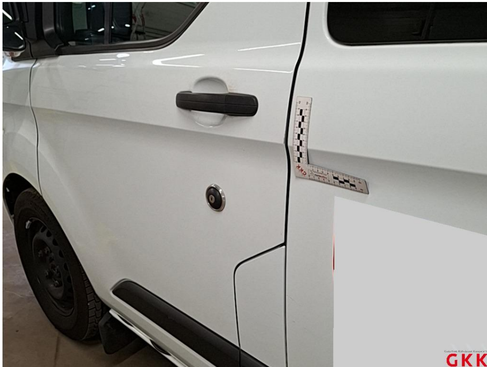
Bild 21 Tür vorne links, Kante, verkratzt, Smartrepair
