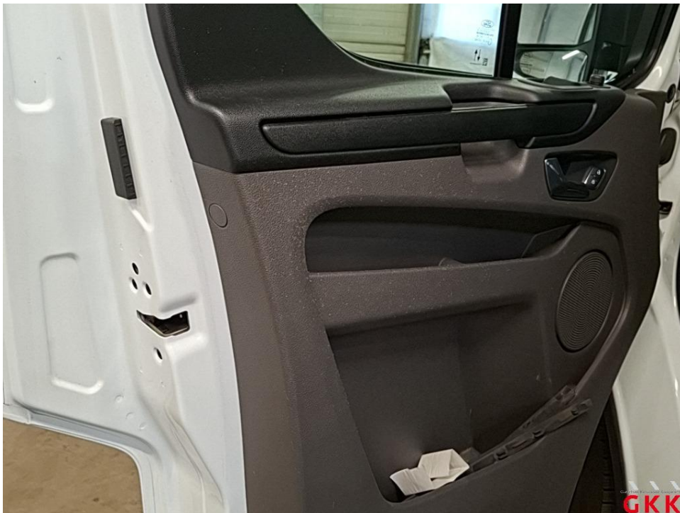
Bild 24 Tür vorne links, Innerverkleidung -Standard-, verkratzt, Smartrepair
