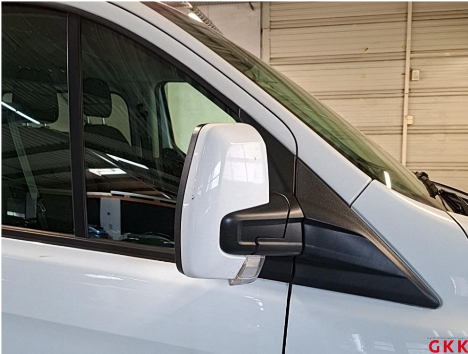
Bild 30 Spiegelgehäuse rechts, Kappe -lackiert-, verkratzt, lackieren ohne LV
