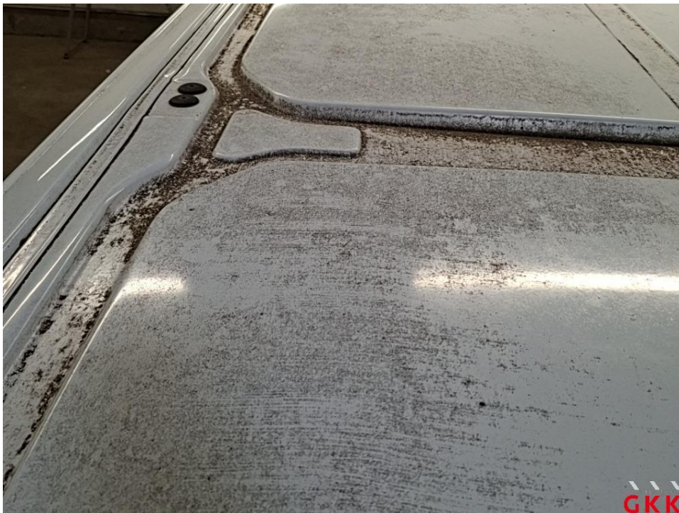
Bild 18 Fahrzeug, außen, Lackierung verwittert / matt, aufbereiten
