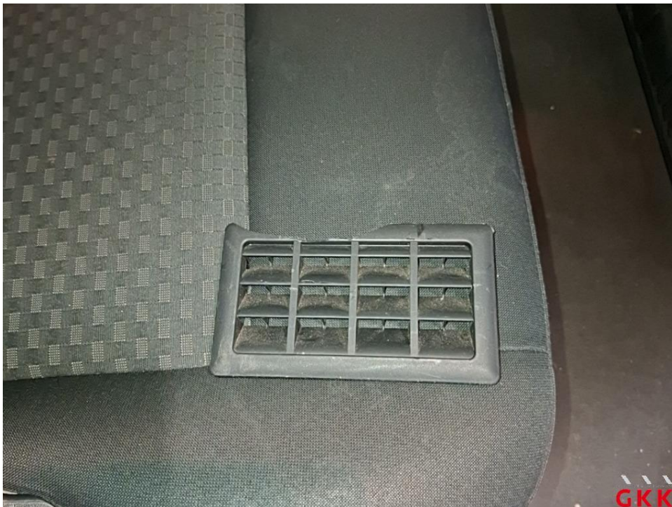
Bild 16 Luftgitter, beschädigt, ersetzen
