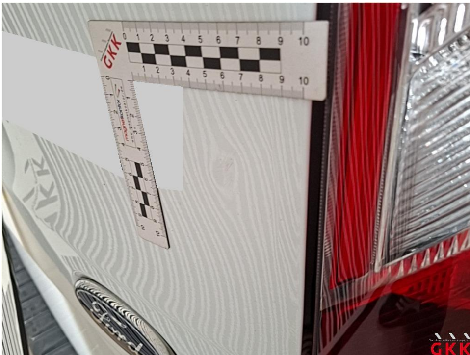
Bild 44 Hecktür rechts, beschädigt, instand setzen - lackieren
