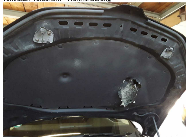
Beschädigung #3: Motorhaube: Dämmmatte - Marderschaden - erneuern
