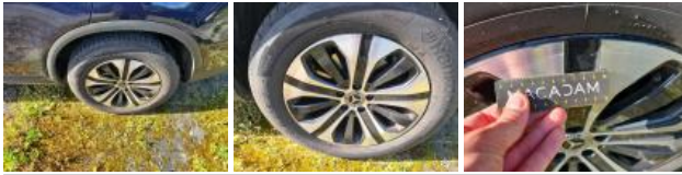
Alloy rim RR bitone/polychrome, Scratch(es), Repair/replace (lump sum)
