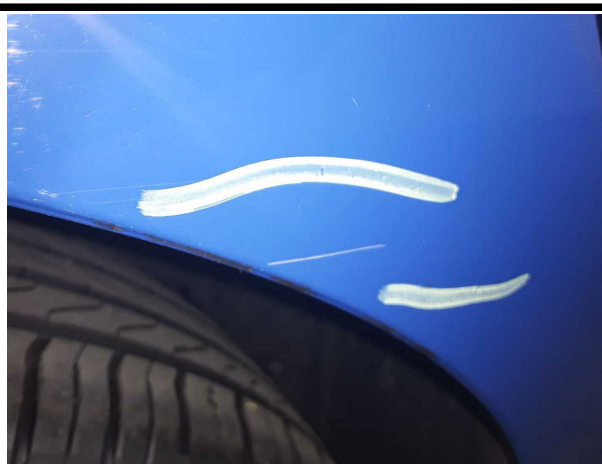
Beschädigung #5: Seitenwand rechts: Seitenwand - verkratzt / verschürft - lackieren
