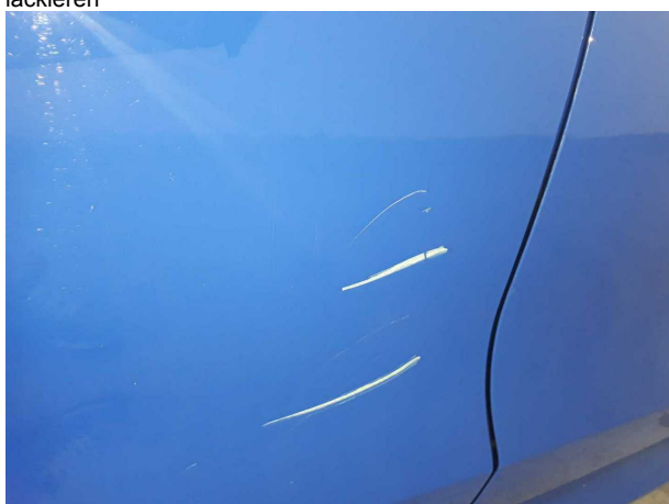
Beschädigung #4: Tür hinten rechts: Tür - verkratzt / verschürft - lackieren
