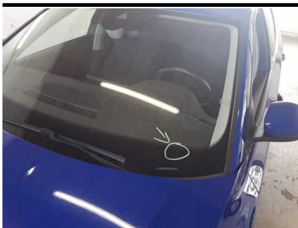
Beschädigung #3: Verglasung: Frontscheibe (Rissbildung) - Steinschlag - erneuern
