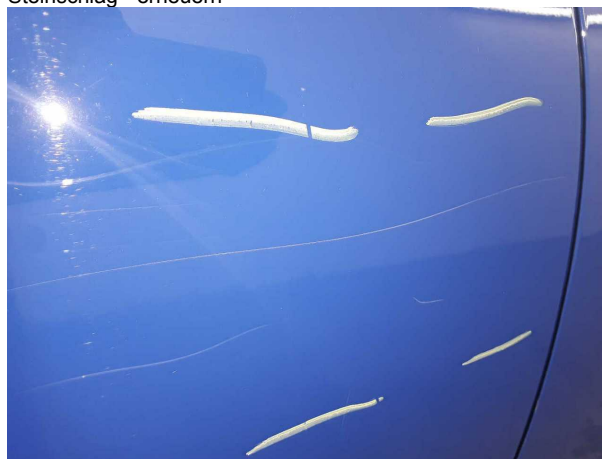
Beschädigung #4: Tür hinten rechts: Tür - verkratzt / versch... - lackieren
