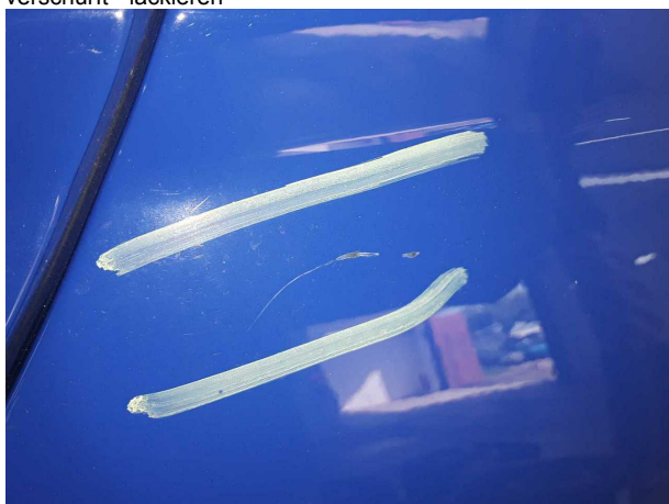
Beschädigung #6: Seitenwand links: Seitenwand - verkratzt / verschürft - lackieren
