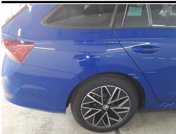
Beschädigung #5: Seitenwand rechts: Seitenwand - verkratzt / verschürft - lackieren
