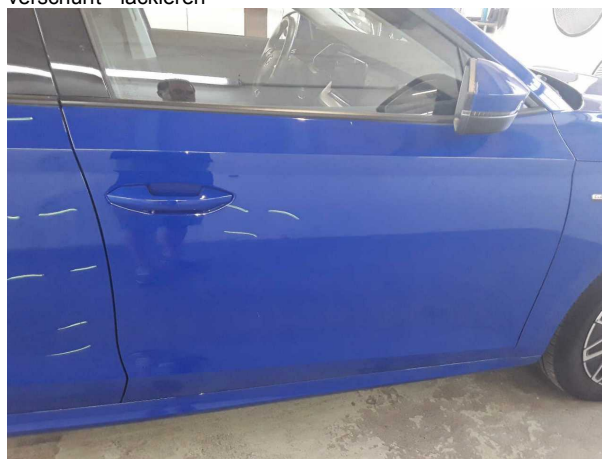
Beschädigung #7: Tür vorn rechts: Tür - verkratzt / verschürft... lackieren
