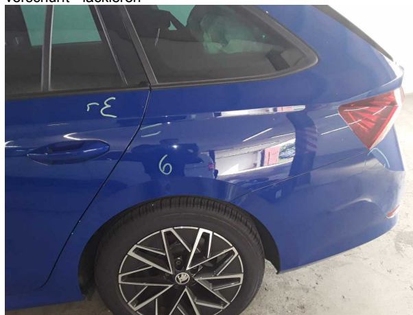
Beschädigung #6: Seitenwand links: Seitenwand - verkratzt / verschürft - lackieren
