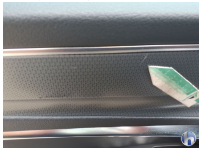
6. Verkleidung Kratzer - Smart Repair
